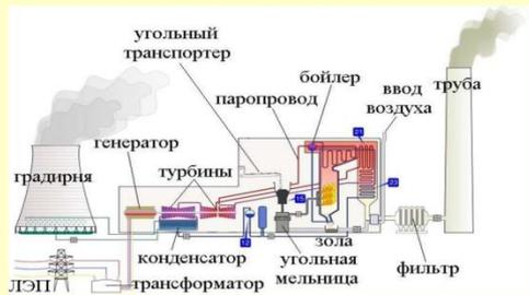
Дополнительные обозначения: 12 – деаэратор, 15 – угледробилка, 21 – паронагреватель, 23 – экономайзер
