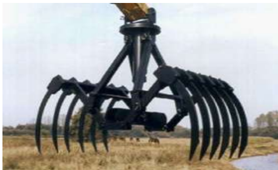
Рис. 279. Грейферный рабочий орган с многозубым захватом
