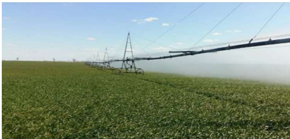
Рис. 352. Широкозахватная машины кругового действия «Фрегат»
