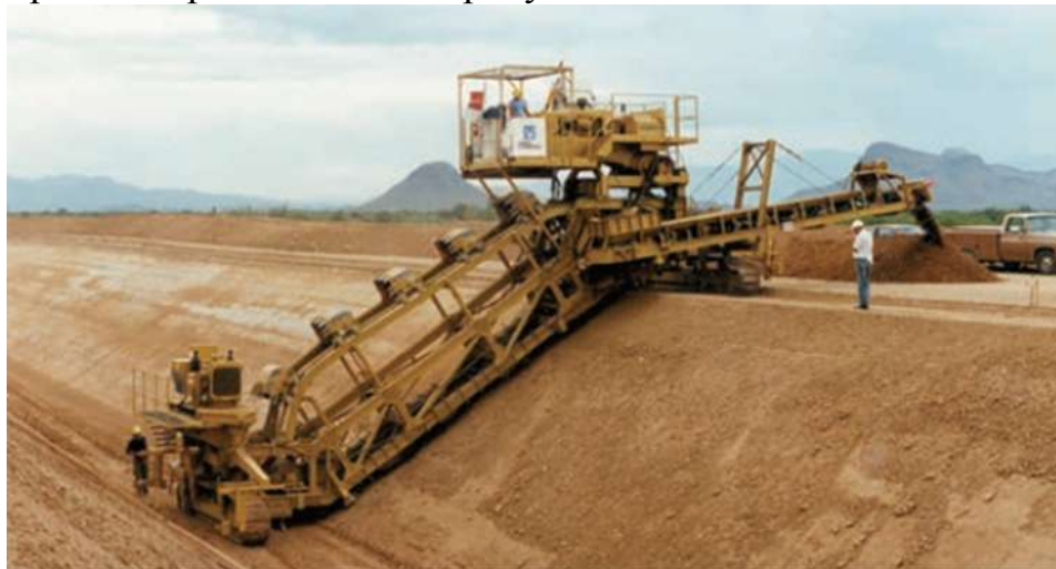
Рис. 291. Многоковшовый неполнопрофильный планировщик
