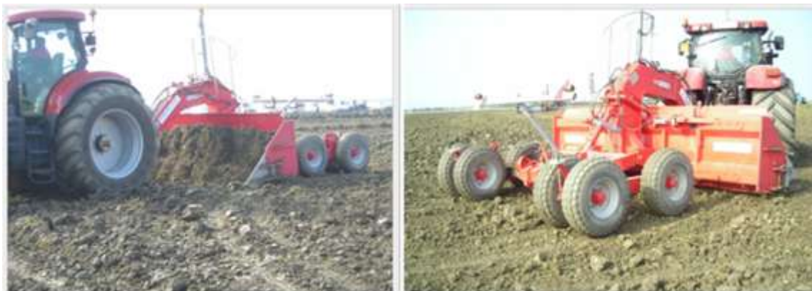
Рис. 330. Итальянские планировщики грунта с лазерным управлением
