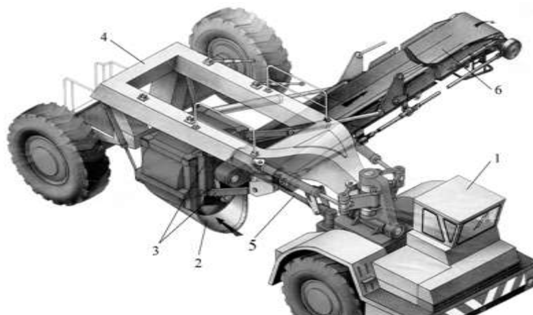
Рис. 163. Общий вид прицепного грейдер-элеватора: 1 – рабочий орган-нож в форме диска; 2 – ленточный транспортёр; 3 – двигатель
