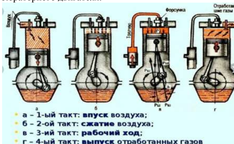
Рис. 59. Принцип работы дизельного двигателя
