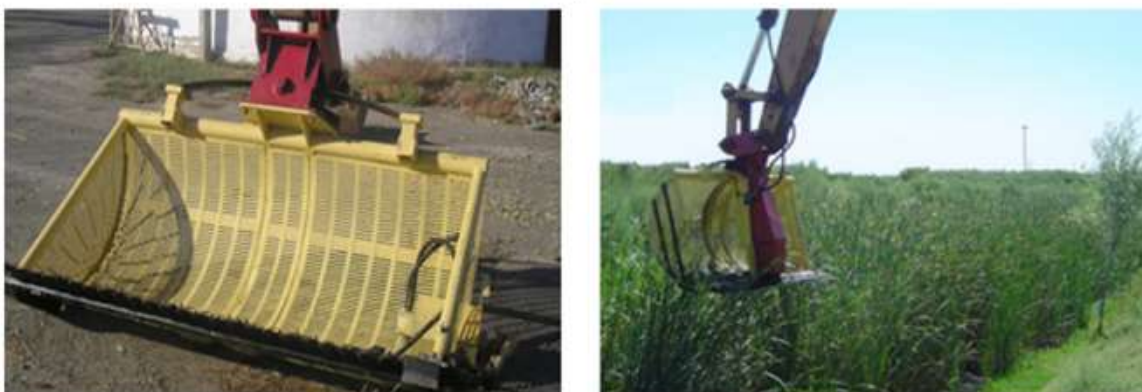
Рис. 285. Общий вид ковша-косилки КК-2,1 с пальцевым режущим аппаратом
