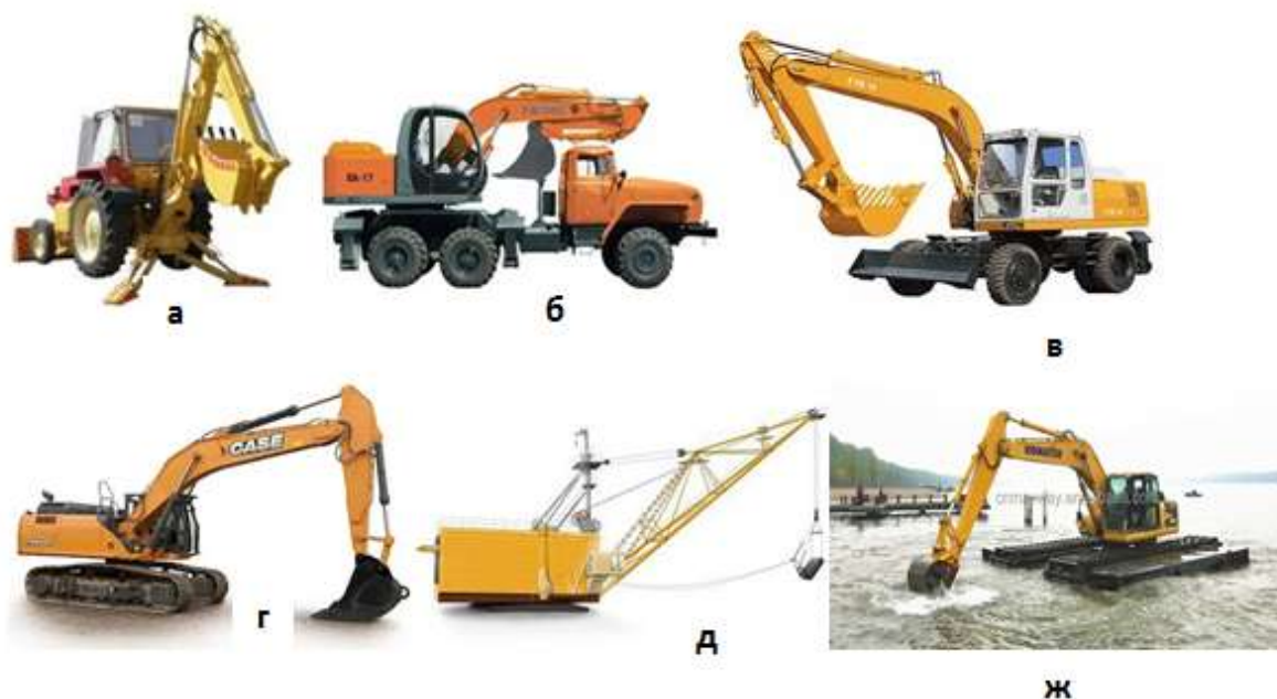
Рис. 132. Одноковшовые экскаваторы на различных по типу шасси
