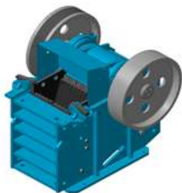
Рис. 195. Схема работы щековой дробилки
