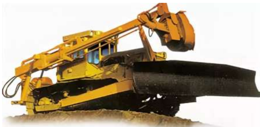
Рис. 276. Каналоочиститель МР-16 со шнекороторным рабочим органом
