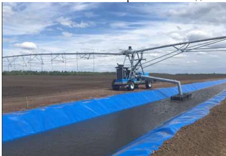
Рис. 357. Дождевальная машина фронтального передвижения работающие в движении
