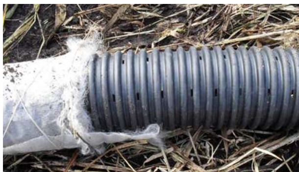
Рис. 305. Дренажная труба с фильтрующим защитным материалом
