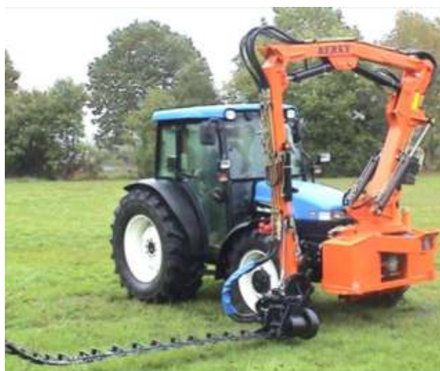
Рис. 281. Косилка с изогнутым двухножевым режущим аппаратом
