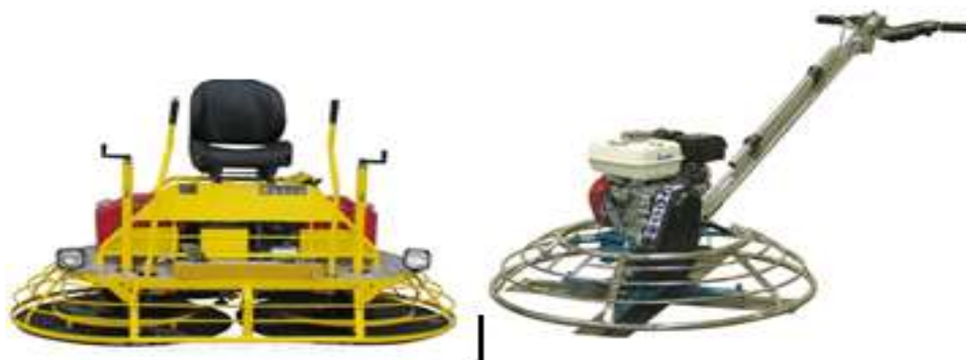
Рис. 228. Затирочная машина для бетона: а) двухроторная, б) однороторная
