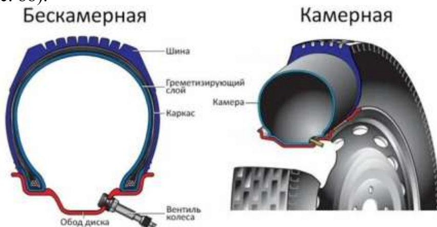
Рис. 88. Сечение бескамерной и камерной шин
