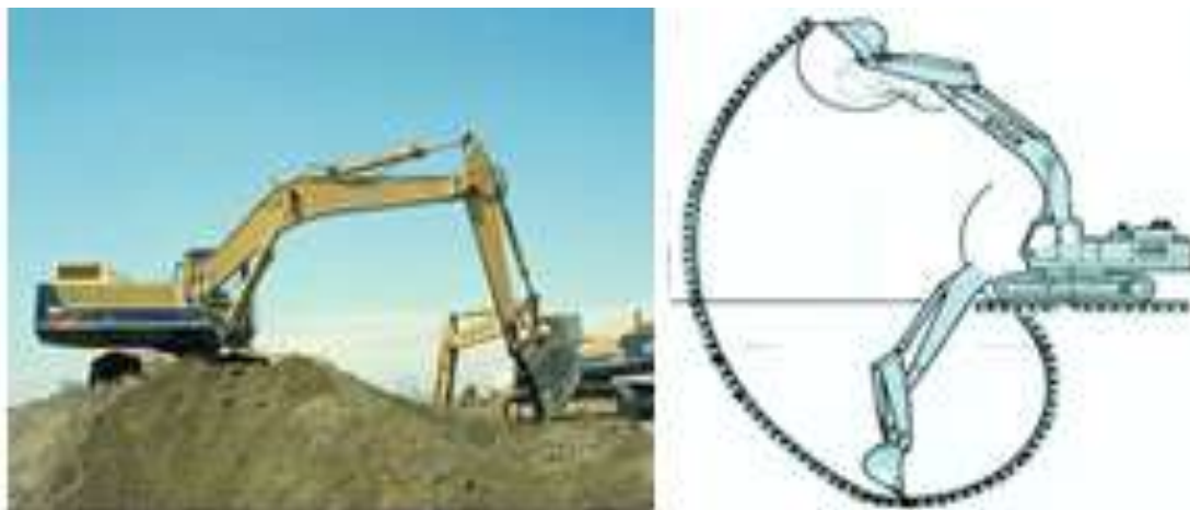
Рис. 137. Экскаватор гидравлический с обратной лопатой
