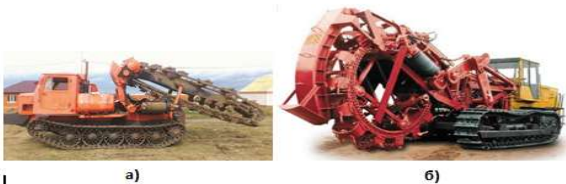
Рис. 144. Экскаваторы продольного копания: а) цепные; б) роторные
