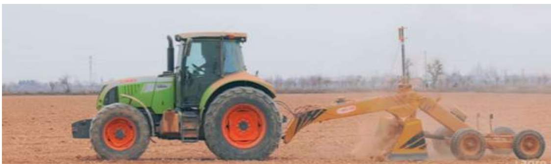
Рис. 329. Процесс лазерной планировки полей в Узбекистане
