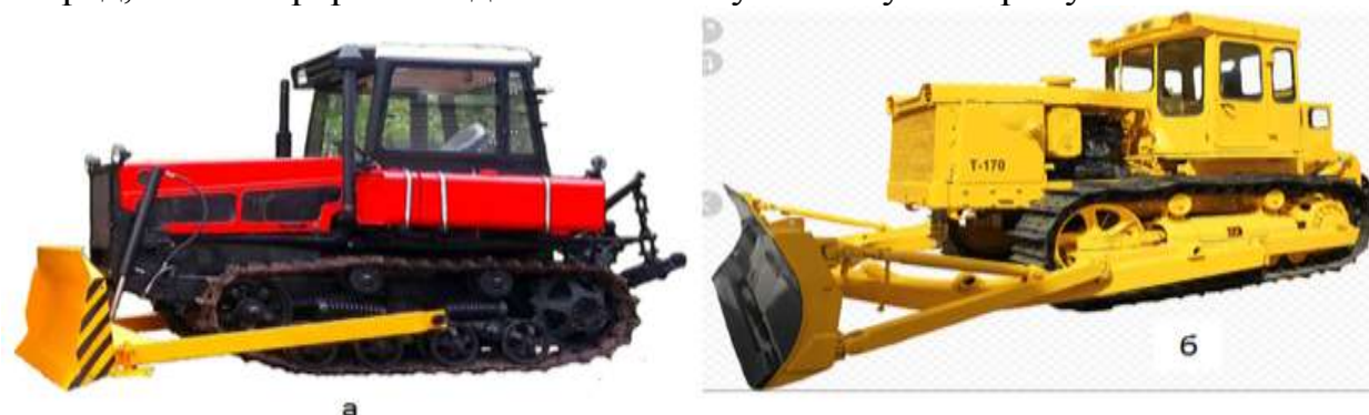
Рис. 151. Бульдозеры по конструкции рабочего оборудования: а) с неповоротным отвалом; б) с поворотным отвалом
