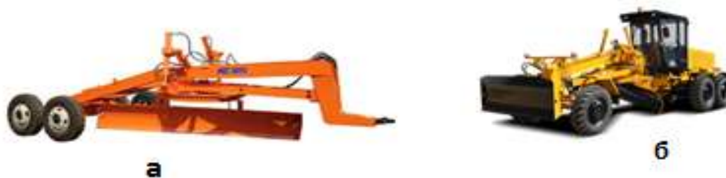
Рис. 159. Грейдеры: а) прицепной; б) самоходный (автогрейдер)
