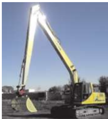
Рис. 286. Ковш-косилка на базе одноковшового гидравлического экскаватора марки GLG 925 LL.
