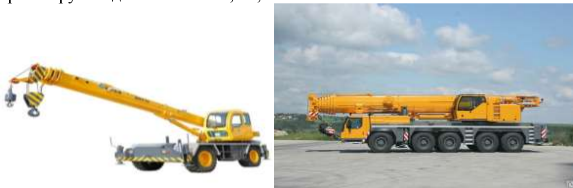
Рис. 114. Вид самоходных стреловых кранов на пневмоколёсном ходу
