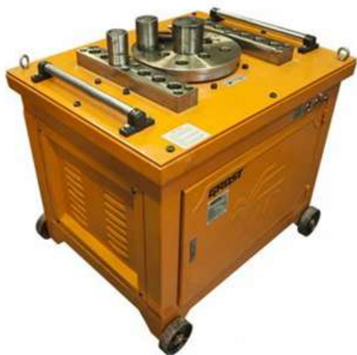
Рис. 222. Станок С-146А для гибки арматурных стержней
