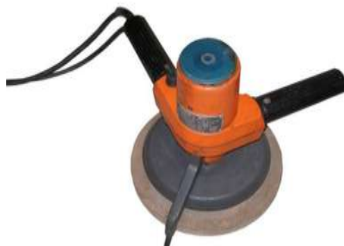
Рис. 226. Штукатурно-затирачная машина с электроприводом
