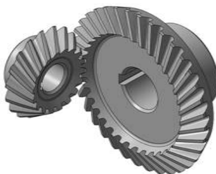
Рис. 33. Конические зубчатые колеса с тангенциальными зубьями
