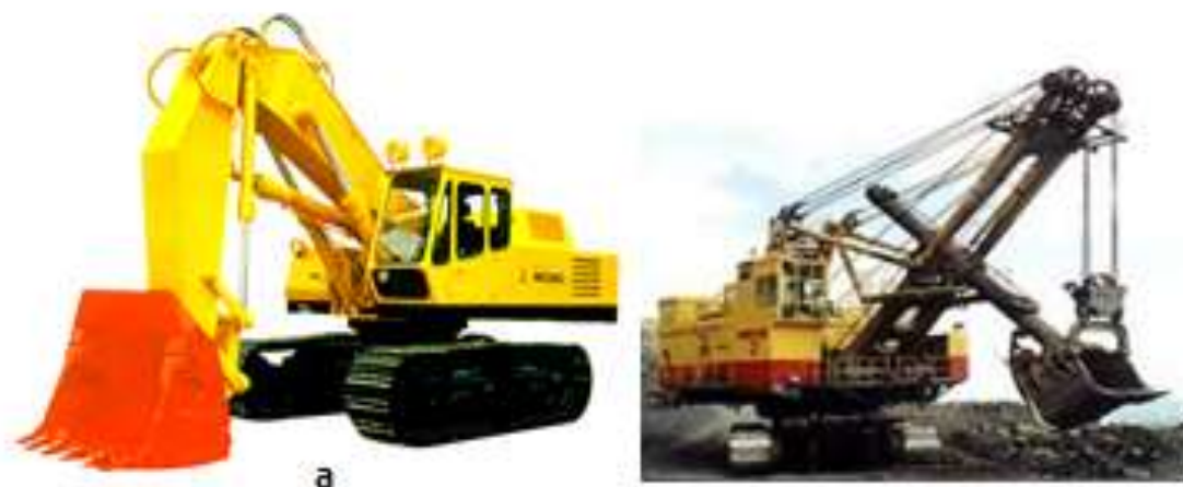
Рис. 136. Общий вид экскаваторов прямая лопата: а) гидравлический; б) механический
