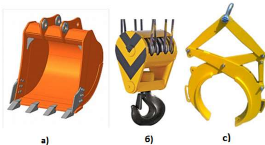
Рис. 96. Переносящие рабочие органы: а) ковш, б) крюк, с) захват
