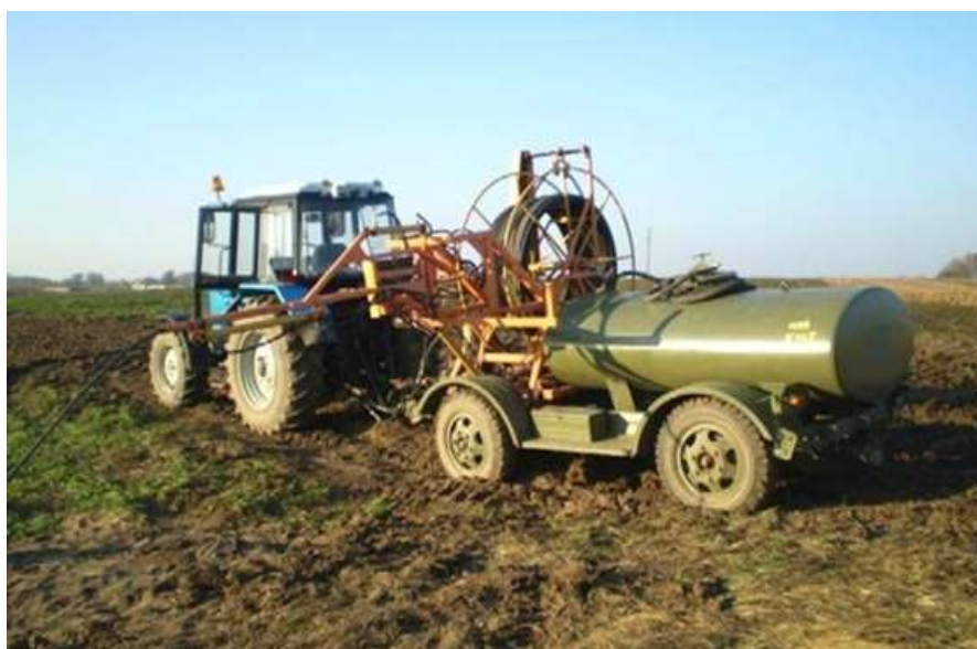
Рис. 313. Общий вид дренопромывочной машины ДП-10А
