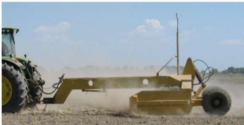
Рис. 326. Короткобазовый планировщик ПАУ-4,2 с лазерным управлением
