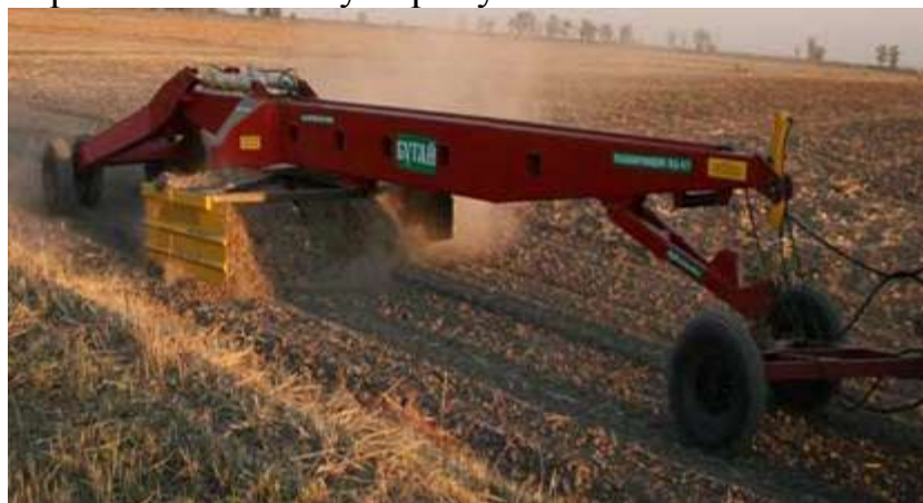
Рис. 258. Работа ковшового длиннобазового планировщика ПД-4,5
