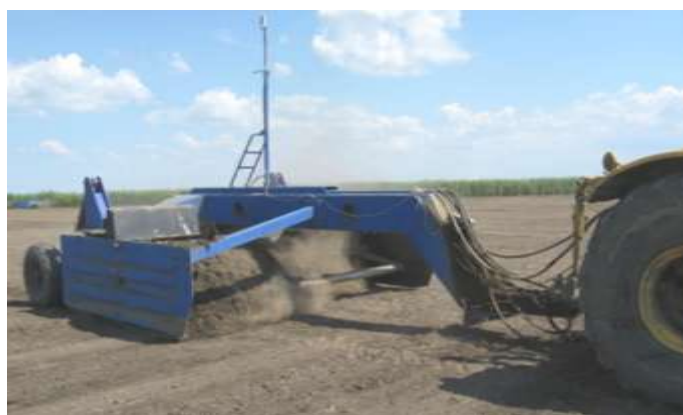
Рис. 327. Короткобазовый скрепер-планировщик СП-4,2 с лазерным управлением
