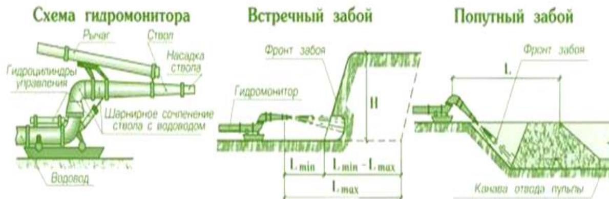
Рис. 166. Гидромониторный способ разработки
