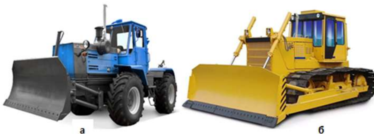
Рис.152. Бульдозеры по типу ходовой части: а) колесный бульдозер; б) гусеничный бульдозер
