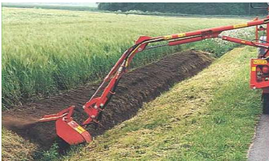
Рис. 273. Процесс очистки канала фрезерным рабочим органом
