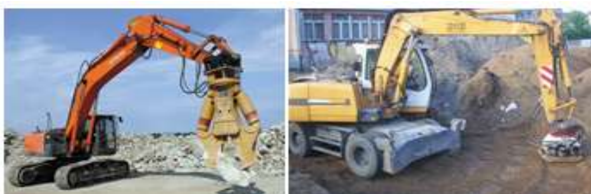
Рис. 142. Экскаватор с рабочим оборудованием: а) гидроножницы; б) вибротрамбовщик
