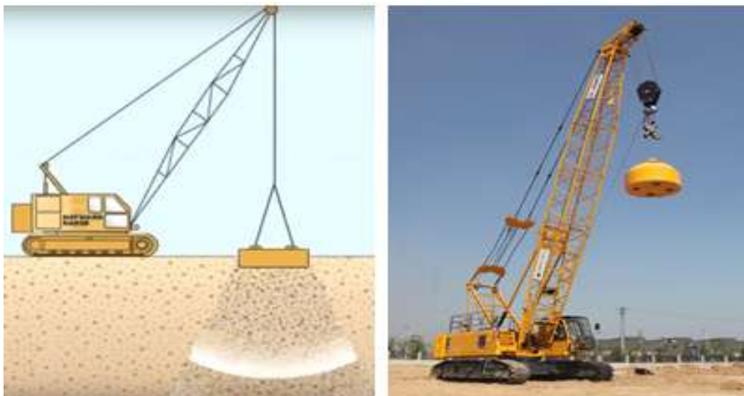
Рис. 174. Схема оборудования для уплотнения грунтов тяжелыми трамбовками
