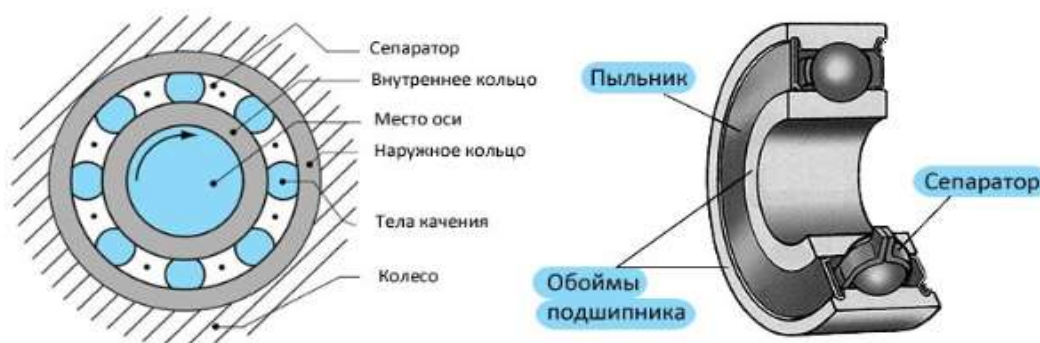
Рис. 24. Схема устройства подшипника качения
