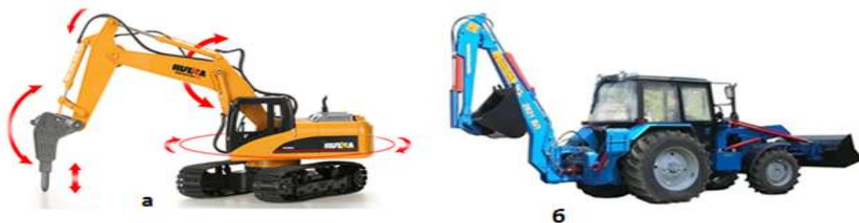
Рис. 133. Одноковшовые экскаваторы: а) полноповоротный; б) неполноповоротный
