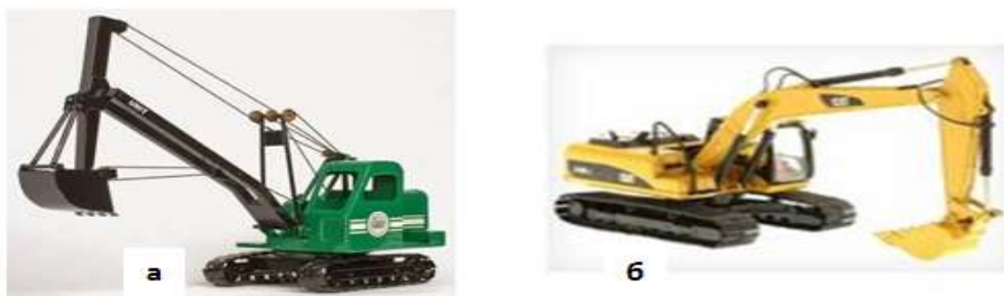
Рис. 134. Одноковшовые экскаваторы по виду установки рабочего: а) с гибкой подвеской рабочего оборудования; б) с жесткой подвеской рабочего оборудования
