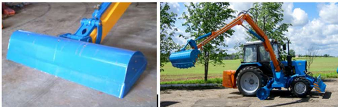
Рис. 278. Вид ковша уширенного поворотного
