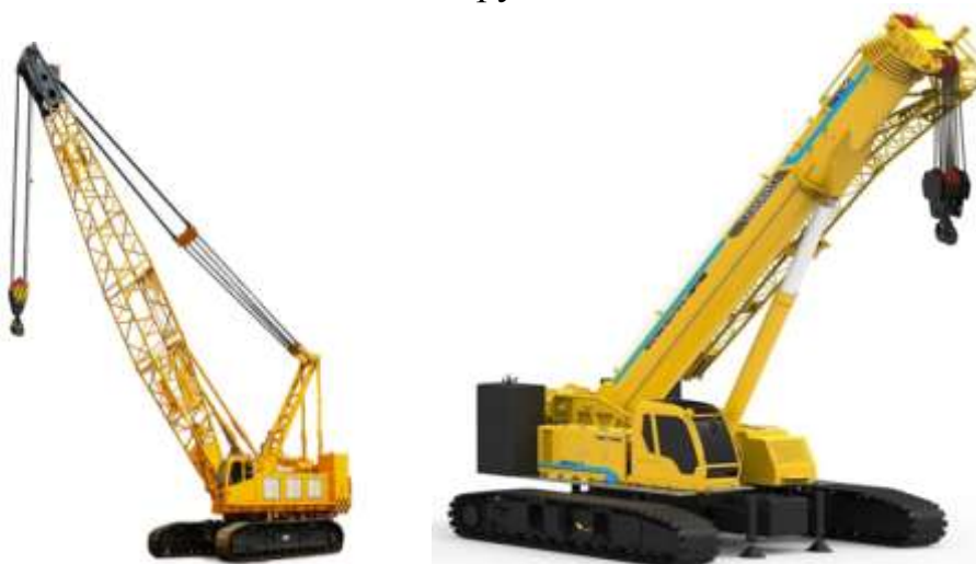
Рис. 113. Вид самоходных стреловых кранов на гусеничном ходу
