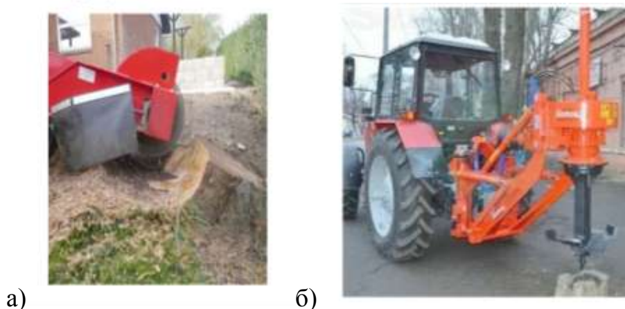
Рис. 249. Измельчители пней: а) дисковый, б) роторный
