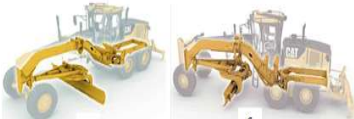
Рис. 161. Исполнения рам автогрейдеров: а) цельная рама; б ) шарнирная рама
