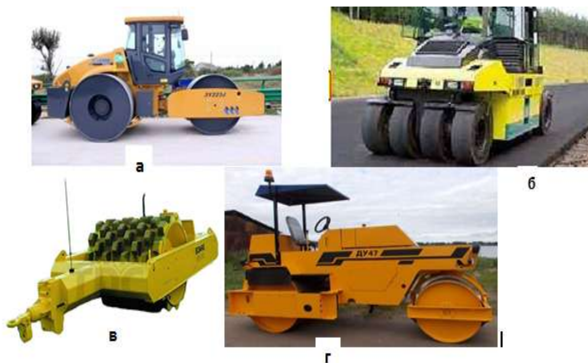
Рис. 172. Типы статических уплотняющих машин: а) трехвальцовый каток; б) пневматический каток; в) прицепной кулачковый каток; г) двухвальцовый каток
