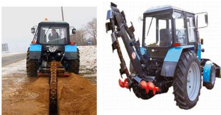
Рис. 145. Цепной экскаватор с рабочим оборудованием скребкового типа
