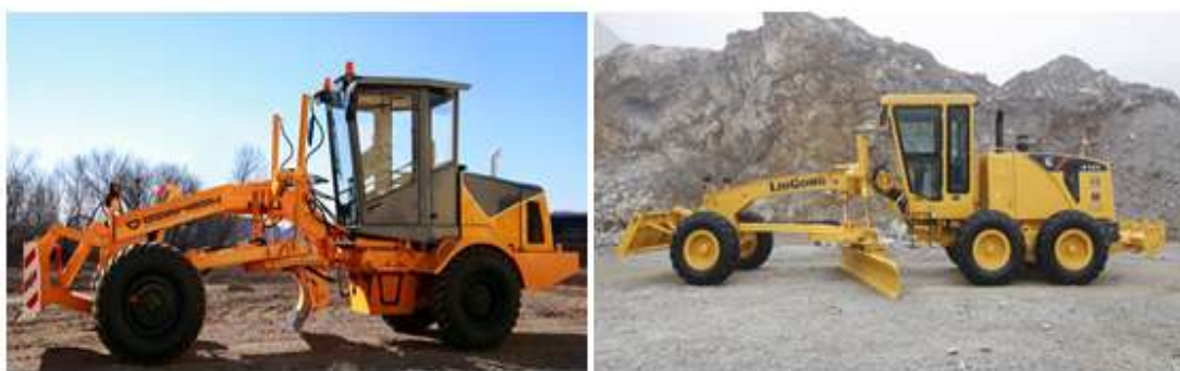
Рис. 162. Автогрейдеры по исполнению ходовой части: а) двухосные; б) трехосные
