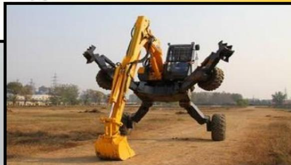
Состоит из колес с пневматическими шинами, надеваемых на мосты. Колеса приводятся в движение ходовой трансмиссией.
