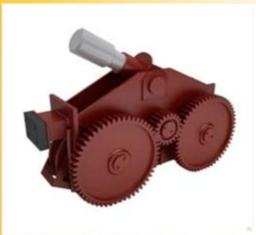
Привод ведущих колес может быть от электродвигателя или ДВС. Приводы оборудуют управляемыми и автоматическими тормозами. Одно или несколько колес с общей рамой, двигателем, редуктором и тормозом образуют приводную ходовую тележку.
