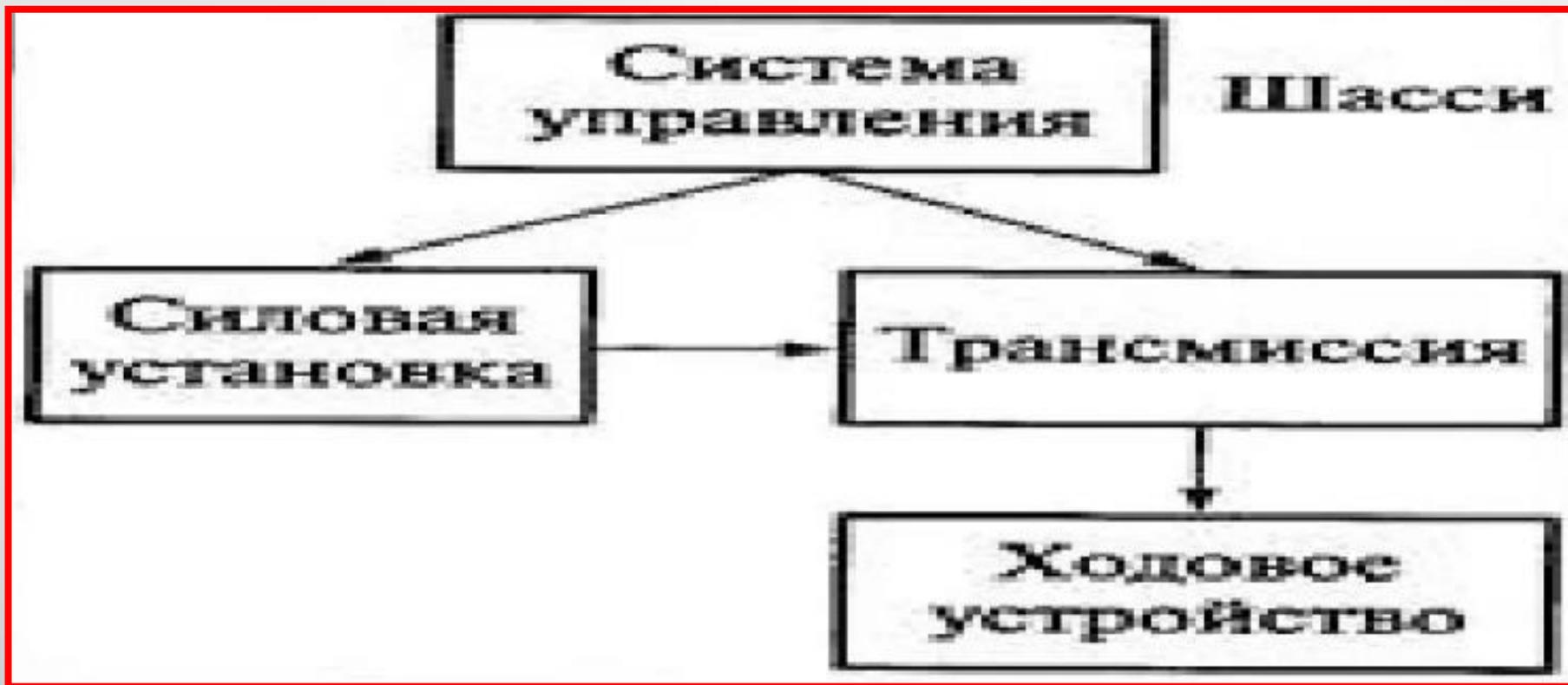
**Системы управления можно разделить на следующие: управление двигателем; управление муфтами и тормозами; рулевое управление; управление рабочим органом (например, опускание и подъем отвала бульдозера или ковша скрепера, поворот отвала автогрейдера).**
