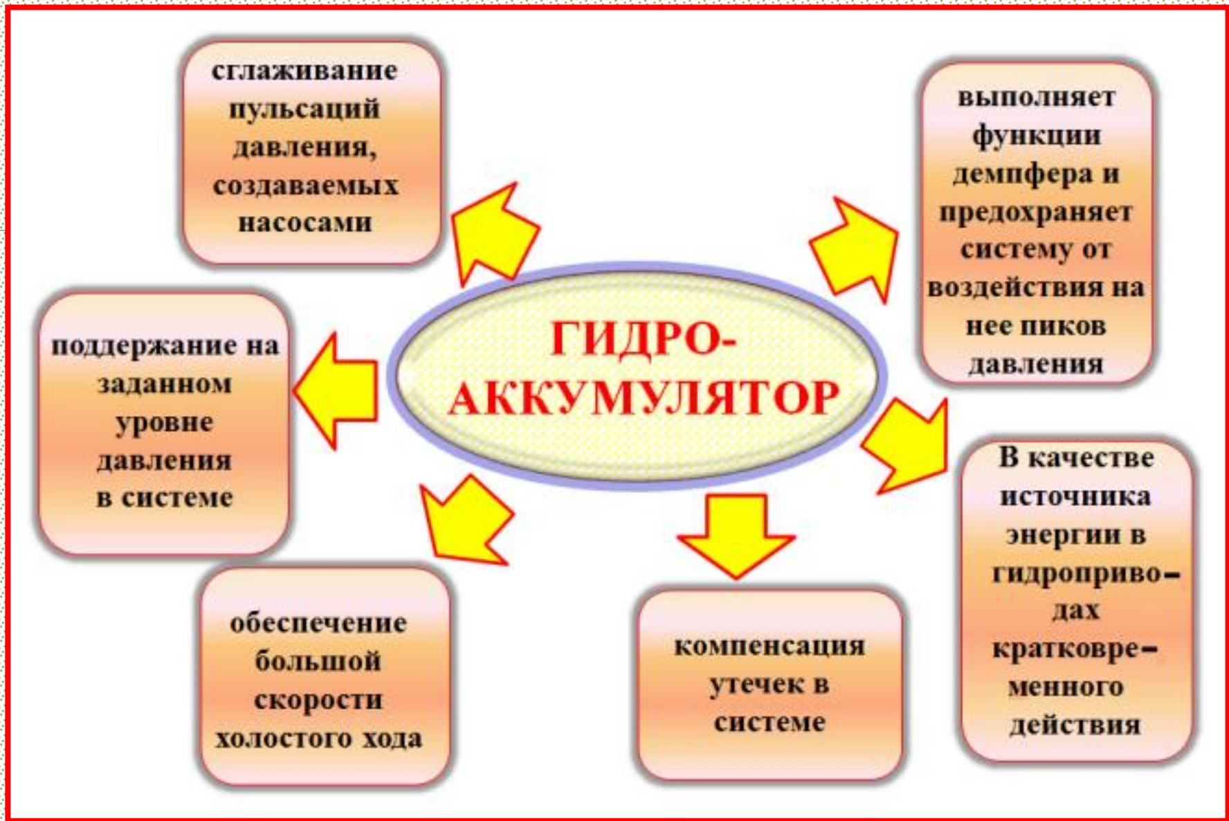
Рис.9. Функции гидроаккумулятора
