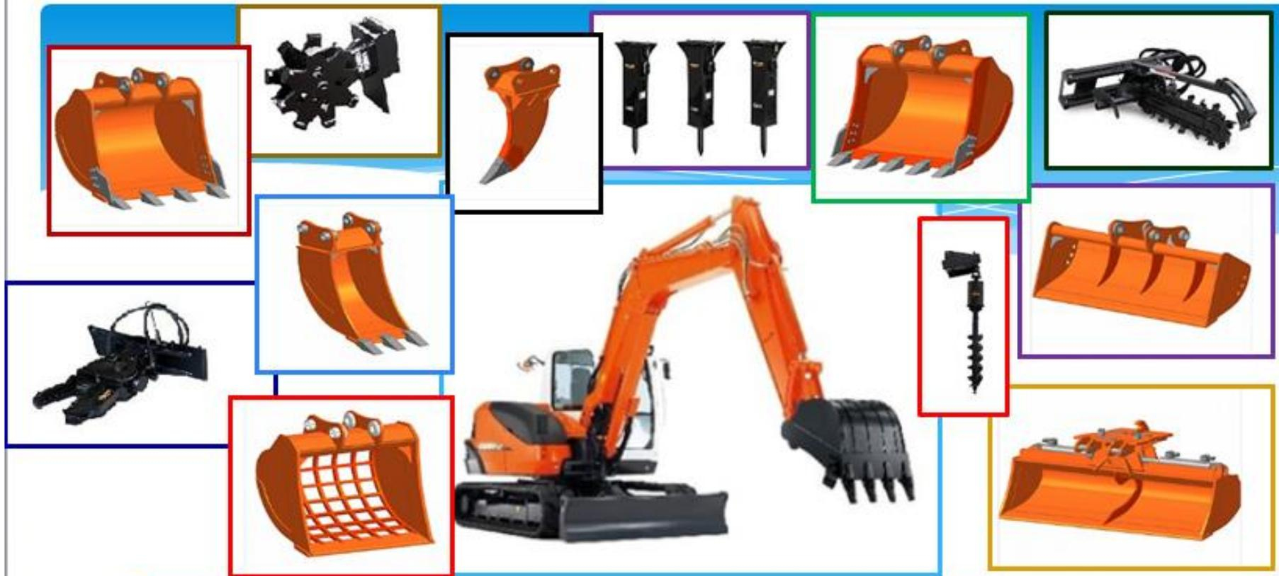
Сменные рабочие оборудование одноковшовых гидравлических экскаваторов
