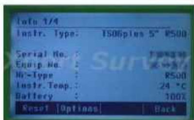
59-rasm. Info tugmasi yordamida priborning quvvati, xotira maydoni va xokazolarni tekshirish
