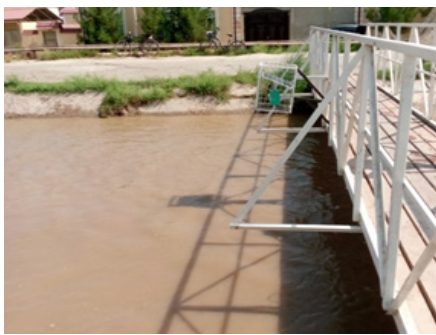
11-расм. Ўзбекистоннинг турли ҳудудларидаги ирригация каналларида ўрнатилган ақлли сатҳ сенсорлари
