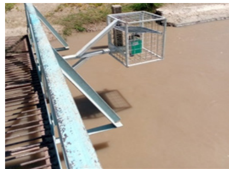
11-расм. Ўзбекистоннинг турли ҳудудларидаги ирригация каналларида ўрнатилган ақлли сатҳ сенсорлари
