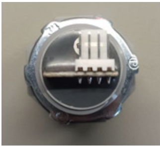
а) 1-расм. MB7580 маркали ультратовушли масофа ўлчагичи: а – юқоридан кўриниши; б – ёнидан кўриниши; в – пастдан кўриниши
