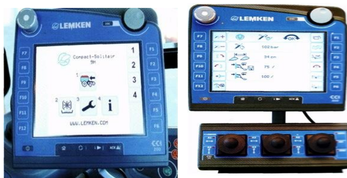
Рис. 4.4. Символы и пиктограммы устройства (а) и подключаемого терминала SSIISOBUS для управления плугом (в)
