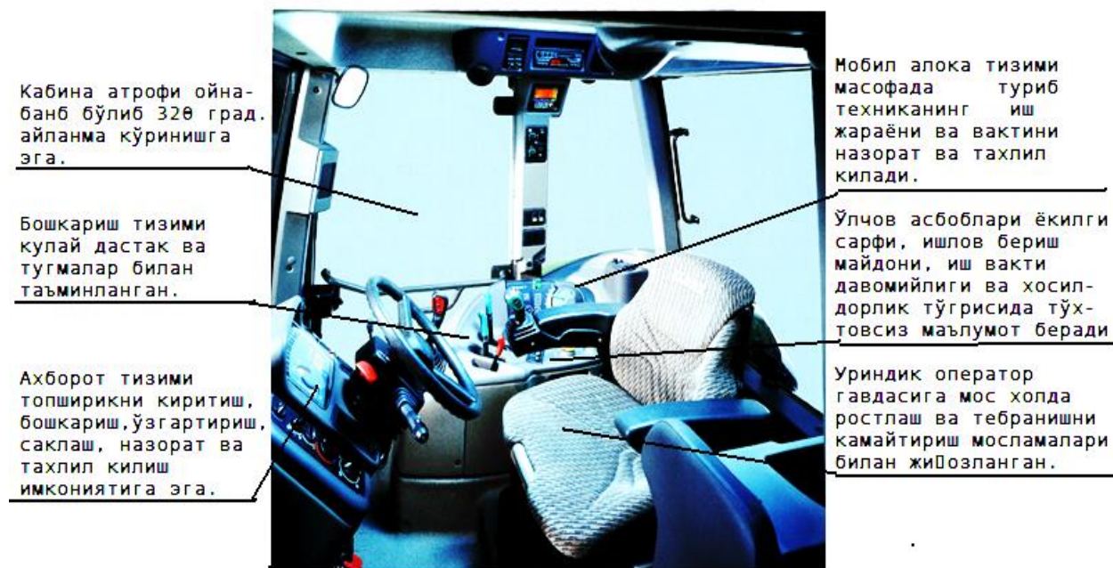
Рис. 4.1. Расположение органов управления и вспомогательного оборудования в кабине трактора ARES 816 фирмы CLAAS.
