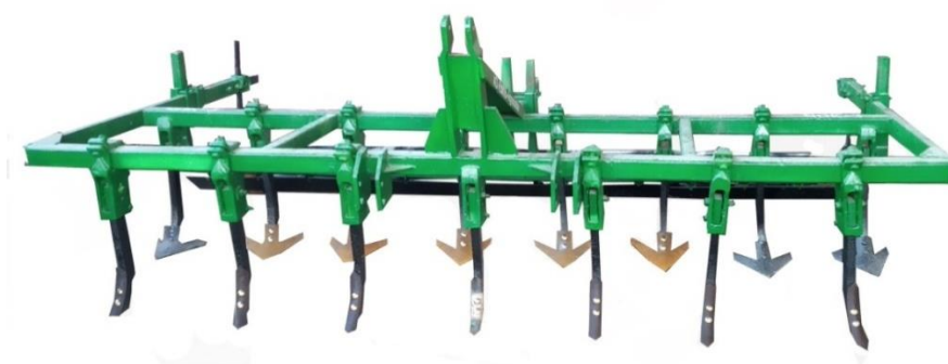
Рис. 3.36. Чизель комбинированный для обработки почвы марки СнРК-3
