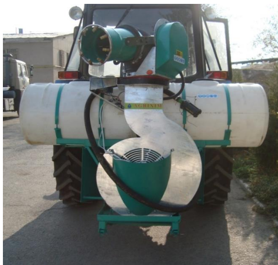
Рис. 3.38. Опрыскиватель марки VP–1 MB-500 агрегатируемая трактором МТЗ-80
