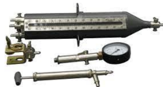
ГР-61 (М) - Батометр вакуумный модернизированный
