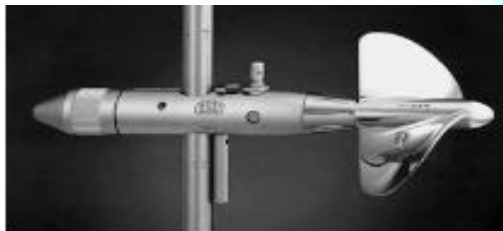
Рис. 7. Универсальный ИСП С-31 (материалы винга: Л – латунь, П – пластик, А – анодированный алюминий, ОТТ-Hydrometrie, г. Кемптцен, Германия) (по [18])
