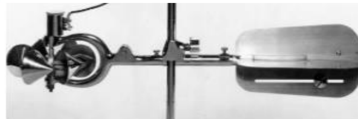
Рис. 8. Вертушка Прайса USGS TYPE AA MODEL 6200 (Rickly Hydrological Company, США) (по [12; 19])
