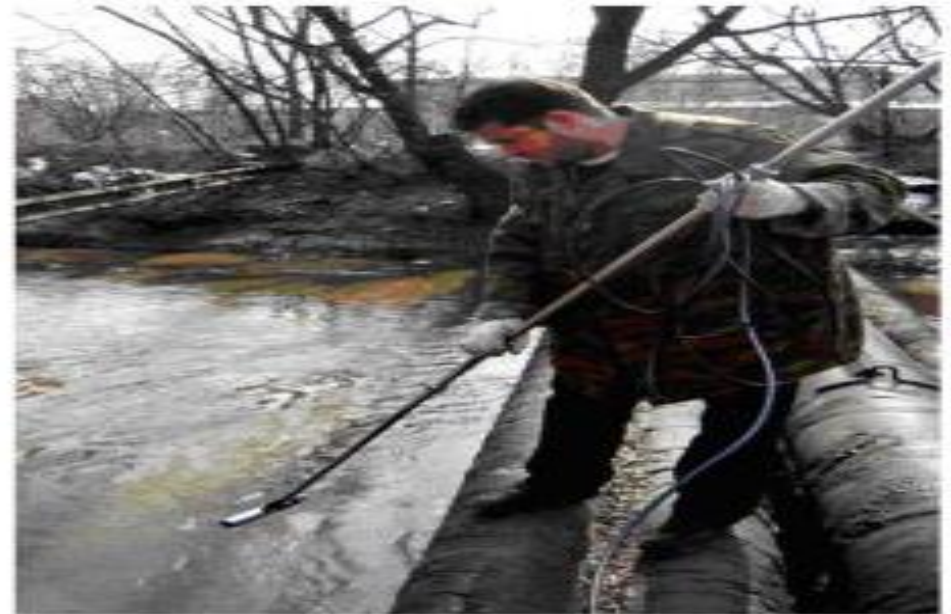
измерителя скорости потока ОТТ
