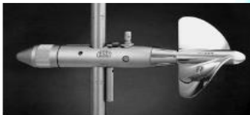
Рис. 7. Универсальный ИСП С-31 (материалы винта: Л – латунь, П – пластик, А – анодированный алюминий, ОТТ-Hydrometrie, г. Кемптен, Германия) (по [18])
