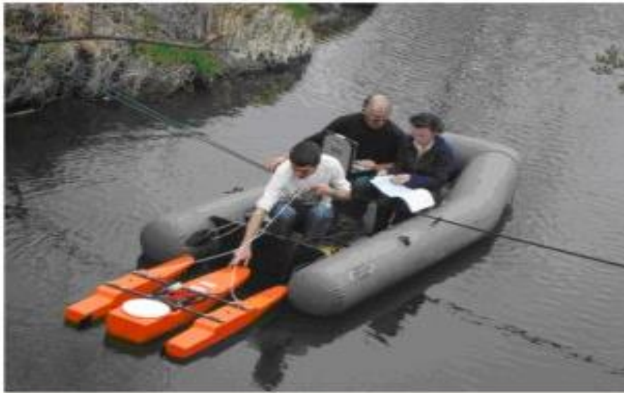
Рис.6. Акустический доплеровский профилограф Rio Grande
