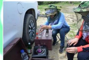
Определение окисляемости воды
