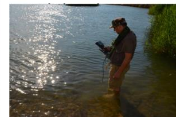
Экстрагирование проб воды на ПХБ
