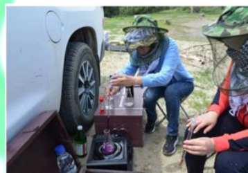
Определение окисляемости воды
