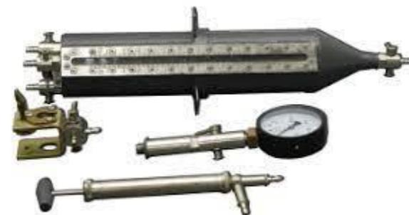
GP-61 (M) - Батометр вакуумный модернизированный
