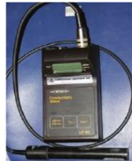
Рис. 1.14. Измерение расхода воды методом ионного паводка: а) гидрологический пост на горной реке; б) кондуктометр Christian Berner AB «WTW LF 95»
