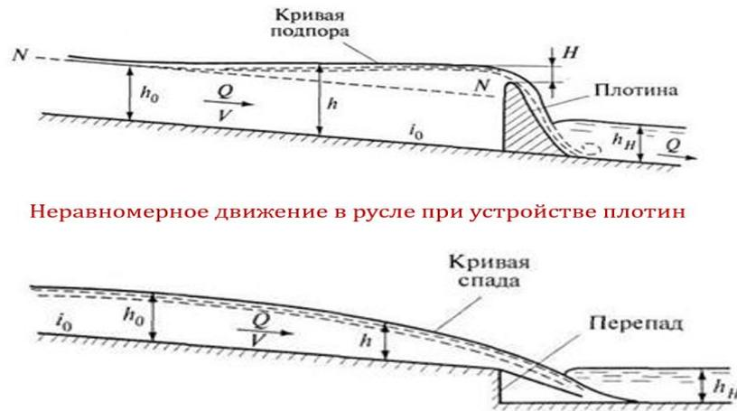
Неравномерное движение в русле при устройстве плотин
