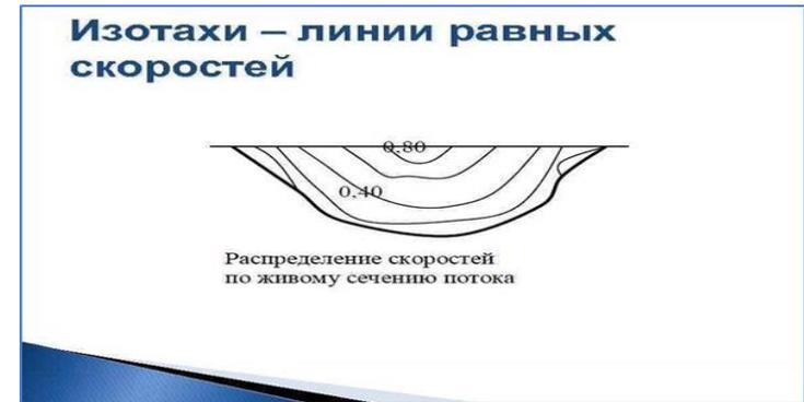
Для потока со свободной поверхностью воды изотахи имеют вид плавных кривых, а их значения, соответствующие им скорости, убывают к берегам и дну.
