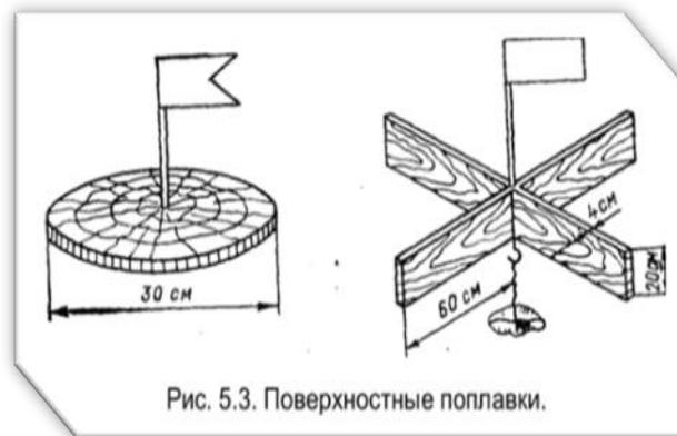
Рис. 5.3. Поверхностные поплавки.
