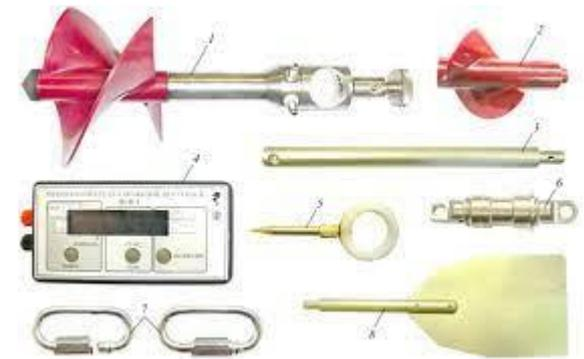
Реже применяют вертушки для интеграционного определения средней скорости на вертикали или, например, средней поверхностной скорости потока.
