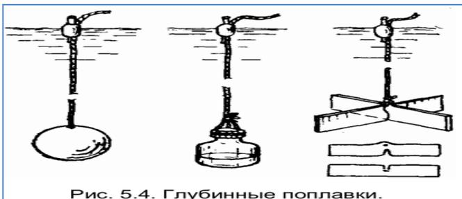
**Глубинные поправки** применяют для измерения скорости и направления течения на некоторой глубине.
