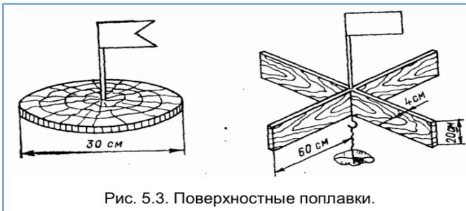
**Поверхностные поправки** применяют для измерения поверхностных скоростей и направлений течения.
