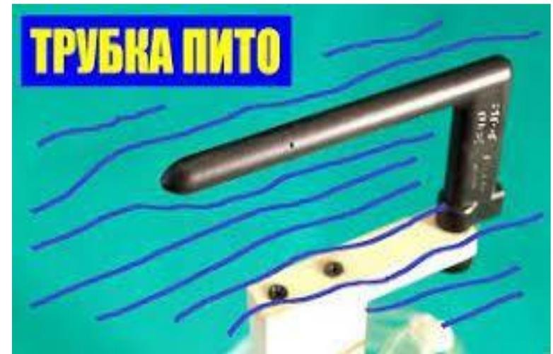
Скоростной напор измеряется непосредственно по высоте подъема уровня в трубке. Гидрометрические трубки дают местную скорость в отдельных точках потока.
