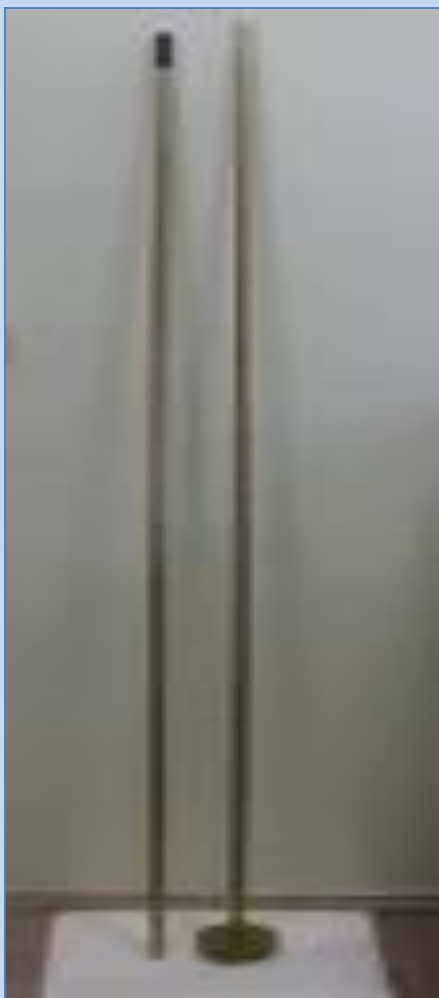
Оддий гидрометрлик штанга (4метрли,пўлатли)
