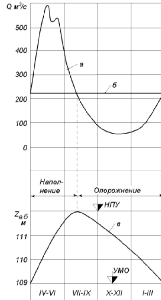
Рис. 5. Схема годичного регулирования стока: а – естественные расходы; б – зарегулированные расходы; в – уровни верхнего бьефа водохранилища
