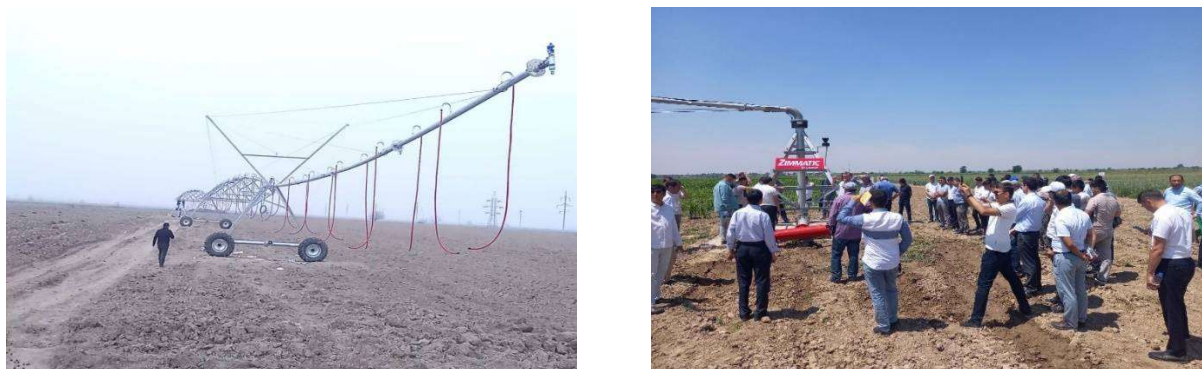
1-расм. 9500P w/ 9500 Series Spans русумли “Zimmatic” ёмғирлатиб суғориш машинасининг ишга тушириш жараёни
