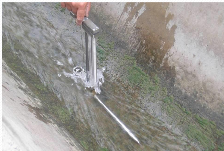
Параболик новни тарировка қилишда Пито найчасидан фойдаланиш
