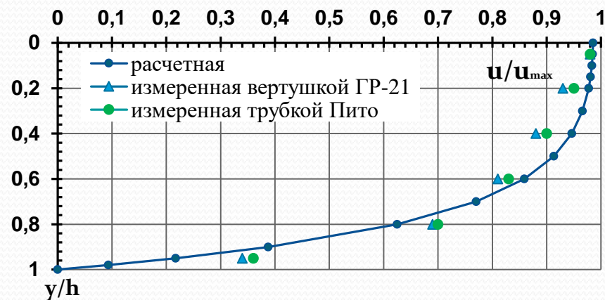
Результаты натурных исследований распределения скоростей по глубине потока на канале БФК (ПК 2100+00)
