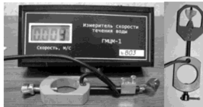
Гидрометрик вертушка ГМЦМ-1 Элиста
