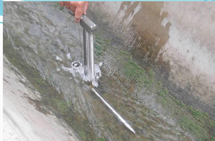
Параболик новда ГТР ёрдамида сув тезлигини ўлчаш
