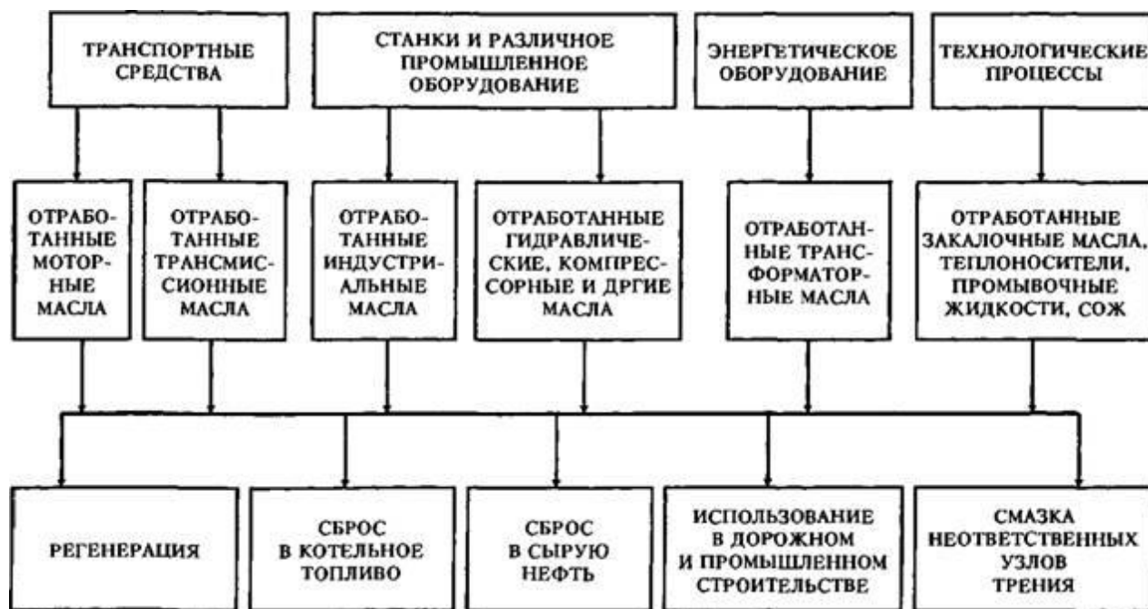
Рис. 13.1. Источники образования и направления утилизации отработанных масел
