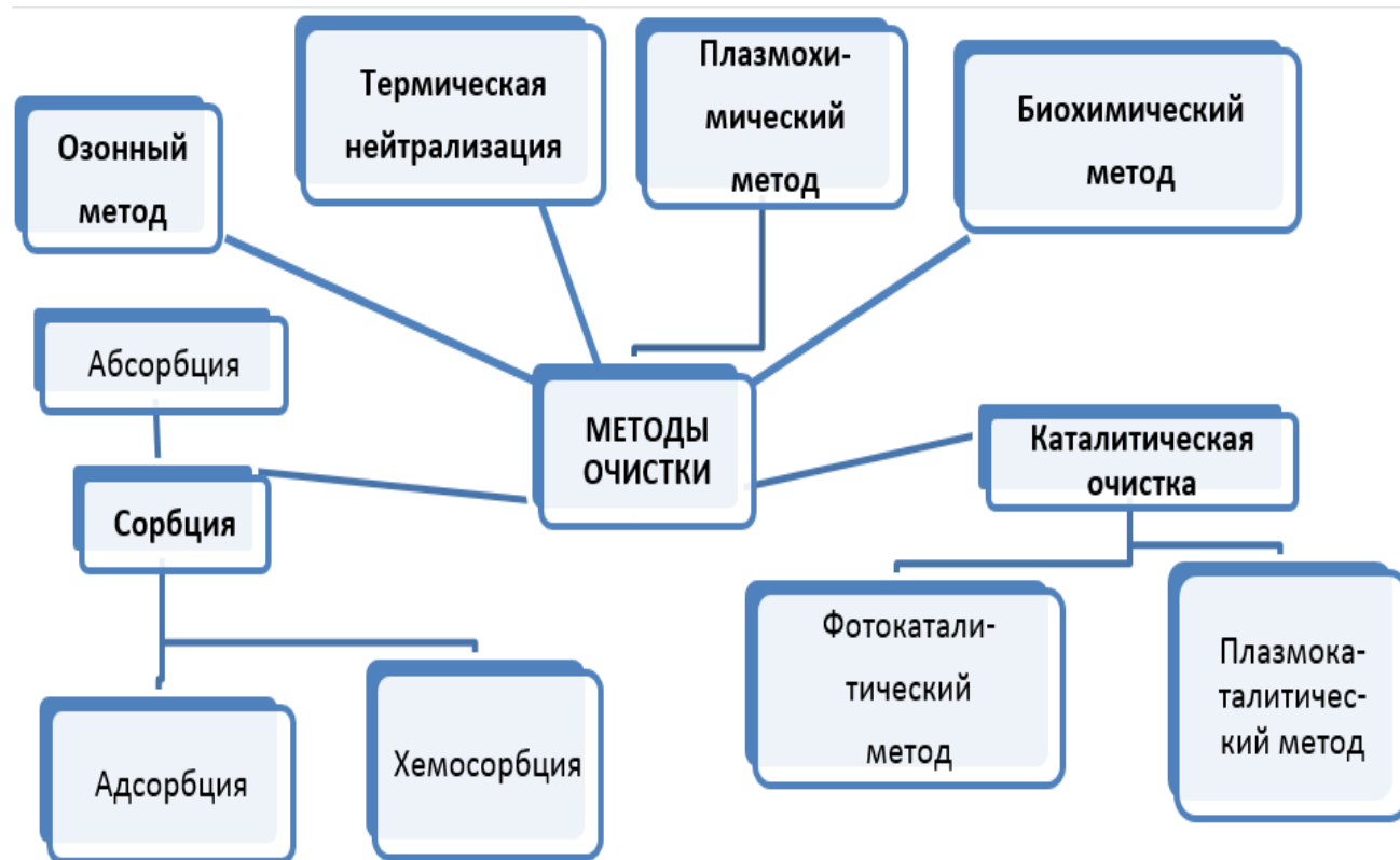
Рис. 16.15. Методы очистки газов с учетом протекания физико-химических процессов
