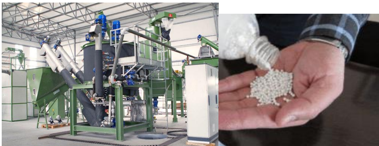
Рис. 6.11. Общий вид линии переработки пластика и готовая продукция (ПЭТ-гранулы)
