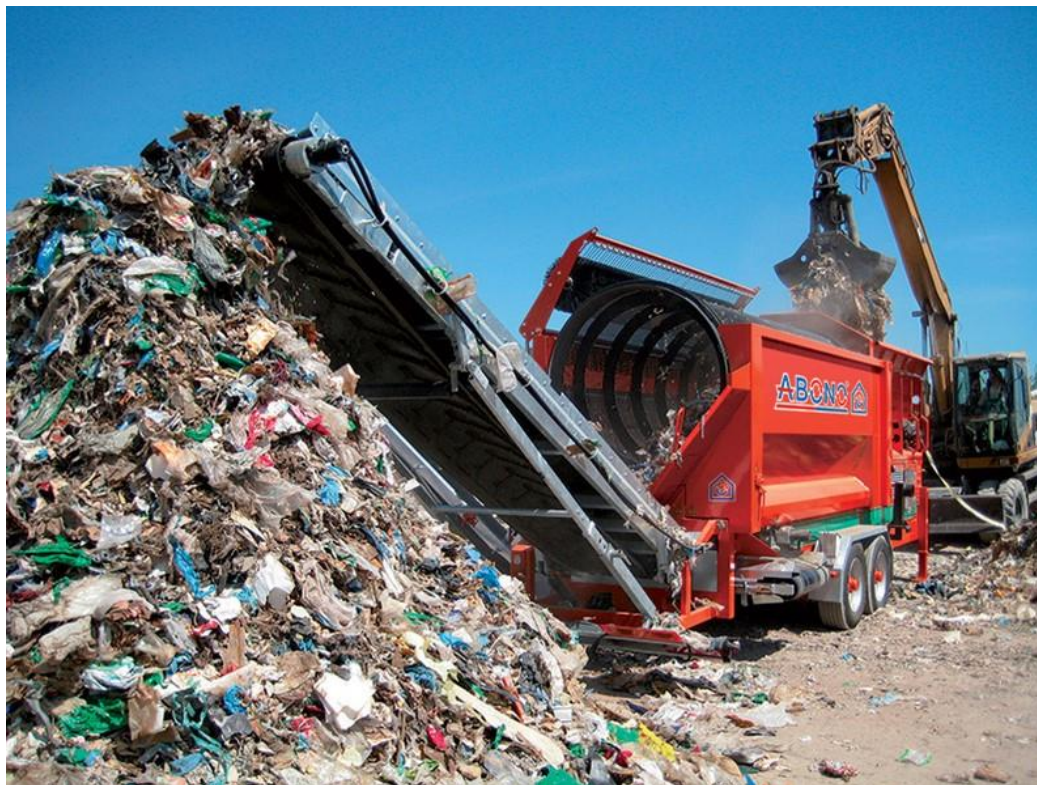
Рис. 5.9. просеивание ТБО на барабанном грохоте
