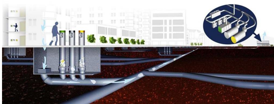
Рис. 4.7. Устройство пневматической системы транспортировки ТБО
