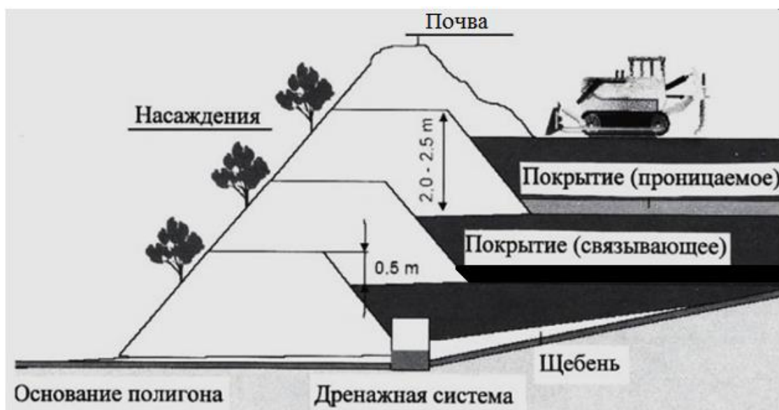
Рис. 10.3. Схема изоляции полигона
