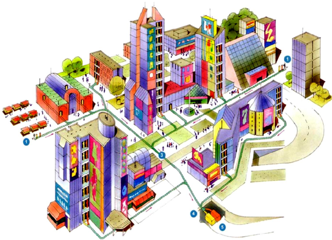
Рис. 4.8. Пневматическая система сбора ТБО в жилой застройке
