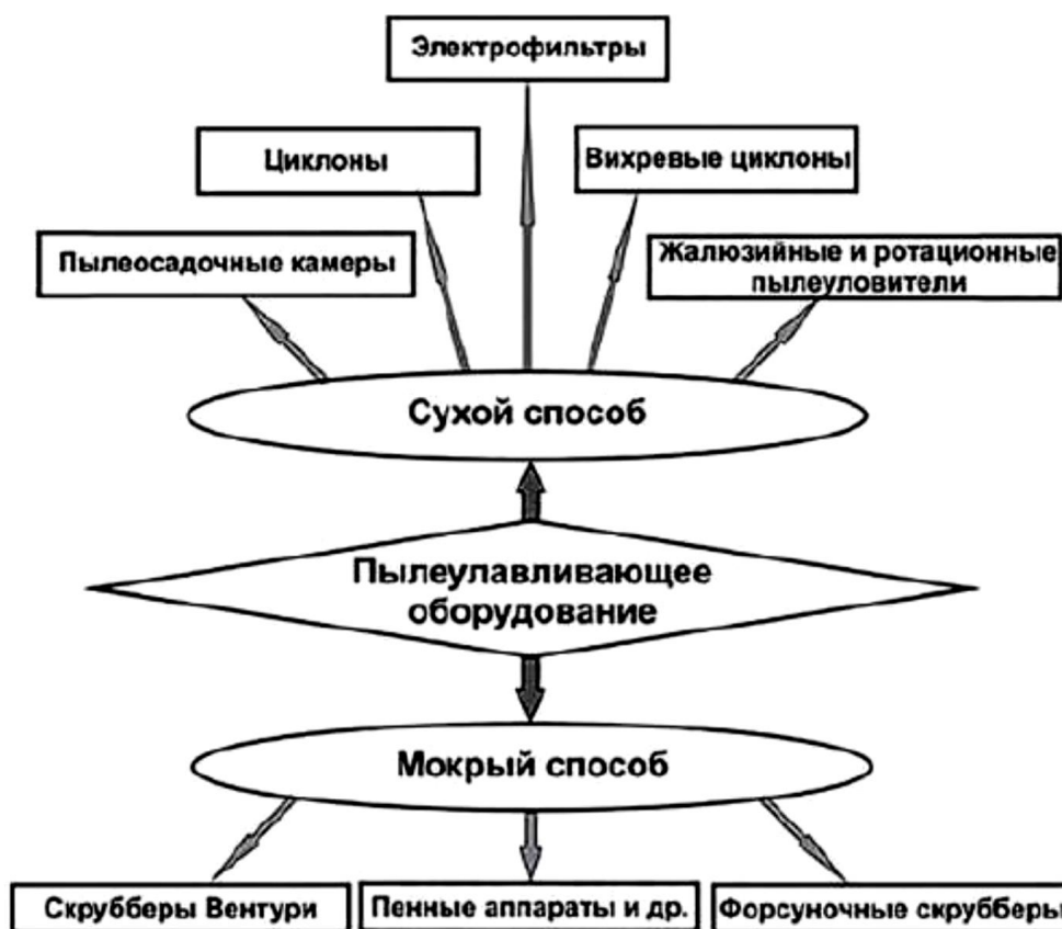
Рис. 16.1. Основные методы очистки выбросов от аэрозолей
