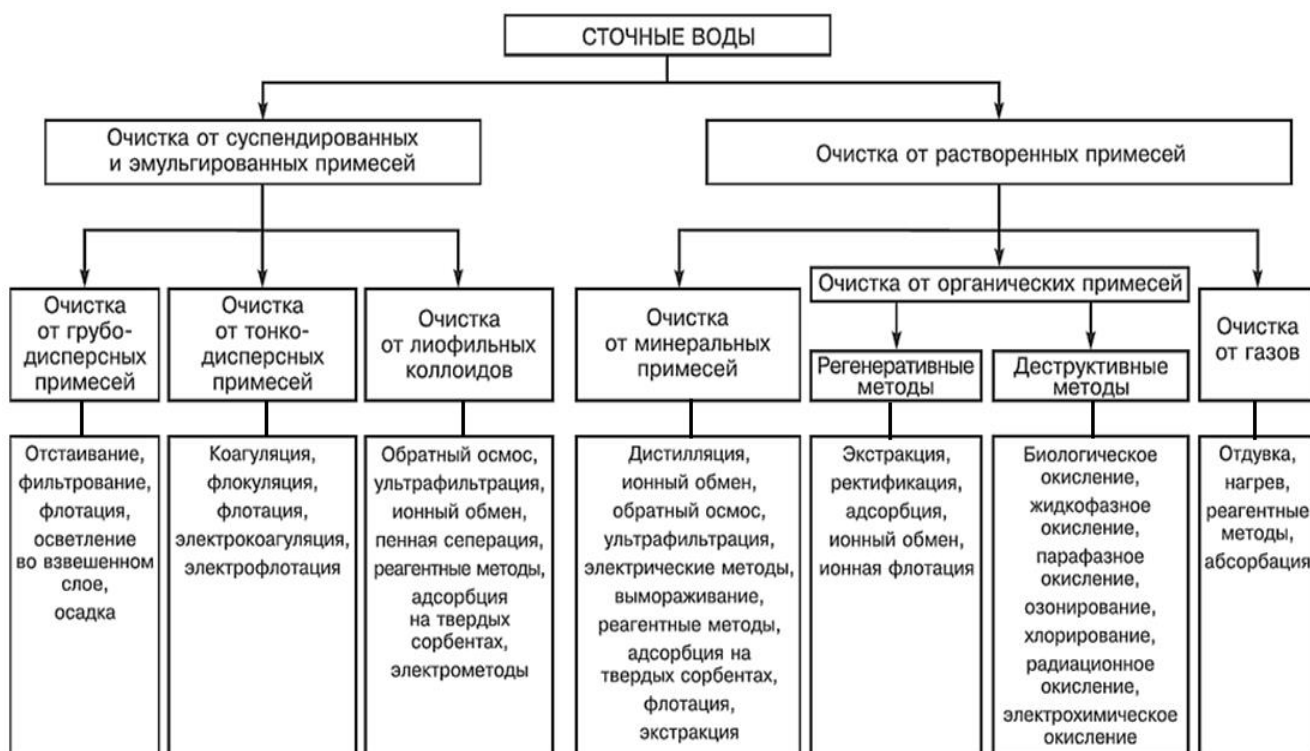
Рис. 14.1. Методы удаления примесей из сточных вод
