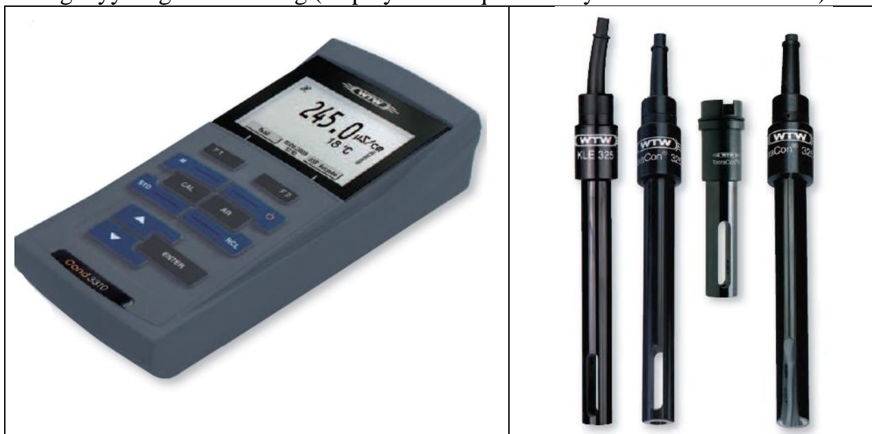
9.2-rasm. Portativ konduktometr Cond 330i elektrodleri
