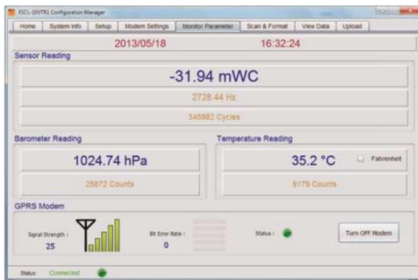
4-rasm. Sensorni o'qish, haroratni o'qish, barometrik bosim va tarmoq signali kuchini birgalikda ko'rsatadigan dastur displeyi
