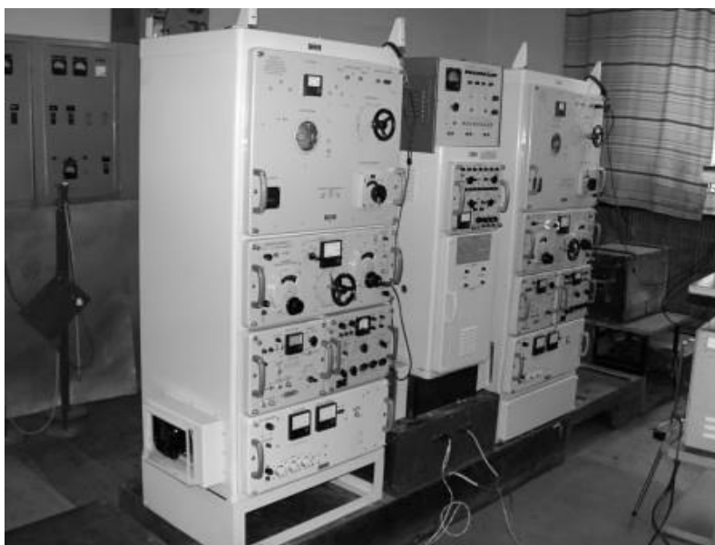
Рисунок 1. Приводная радиостанция ПАР-10 в стационарном варианте
