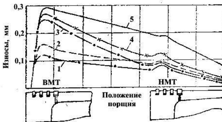
**Рисунок 1** Степень влияния абразивной частицы пыли на процесс изнашивания цилиндров двигателя
