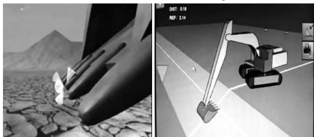
5-расм. Тавсия этилаётган фойдали модел билан канал ва коллекторларнинг ён деворларини қазши жараёни.
