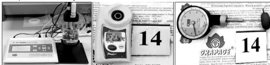
1-расм. Узумнинг сифат хусусиятларини аниқлашда фойдаланилган лаборатория жиҳозлари: а) иономер; б) рефрактометр; с) пенетрометер.
