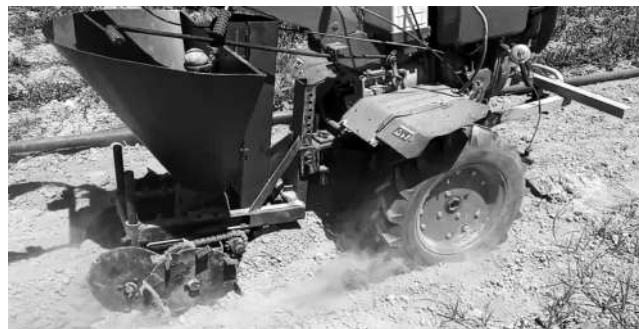
Рис. 2. Вид картофелесажалки в рабочем процессе
