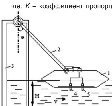
Рис. 1. Измерительная система на основе поплавкового преобразователя расхода воды в канале.
