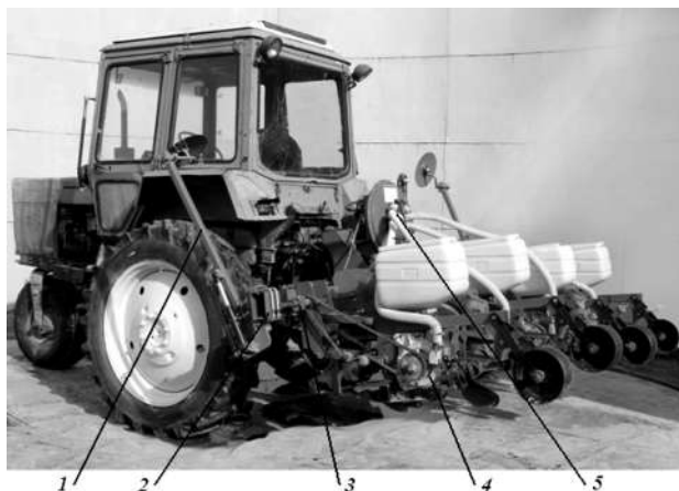
1-расм. Сеяланинг умумий кўриниши: 1 – маркер; 2 – рама; 3 – юритма механизми; 4 – экиш секцияси; 5 – пневмотизим
