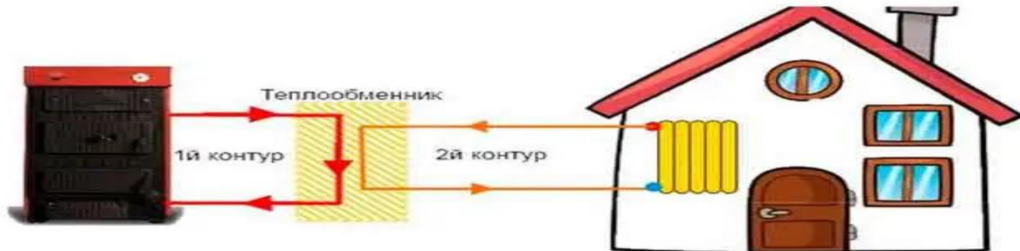
закрытая система водоснабжения
