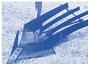
a) b) a – umumiy ko'rinishi; b – vintsimon plastinkali 4-rasm. Plastinka chiviqli ag'dargichli korpus
