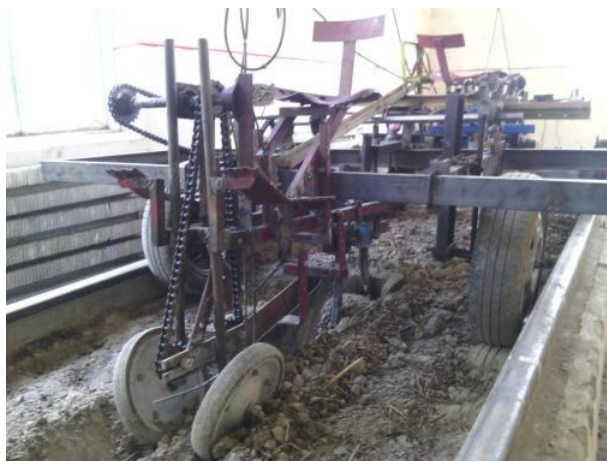
Рис.2. Фрагмент исследования работы прикатывающих катков
