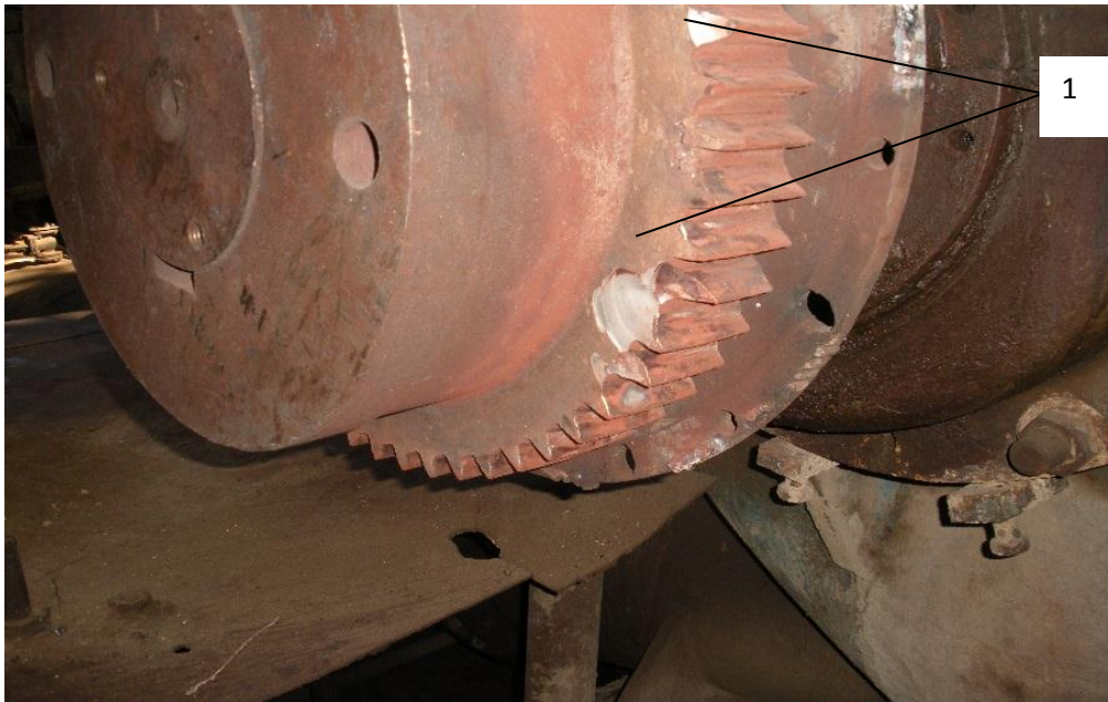
1-nasosni biriktirish muftasi tishlarining sinish holati.
