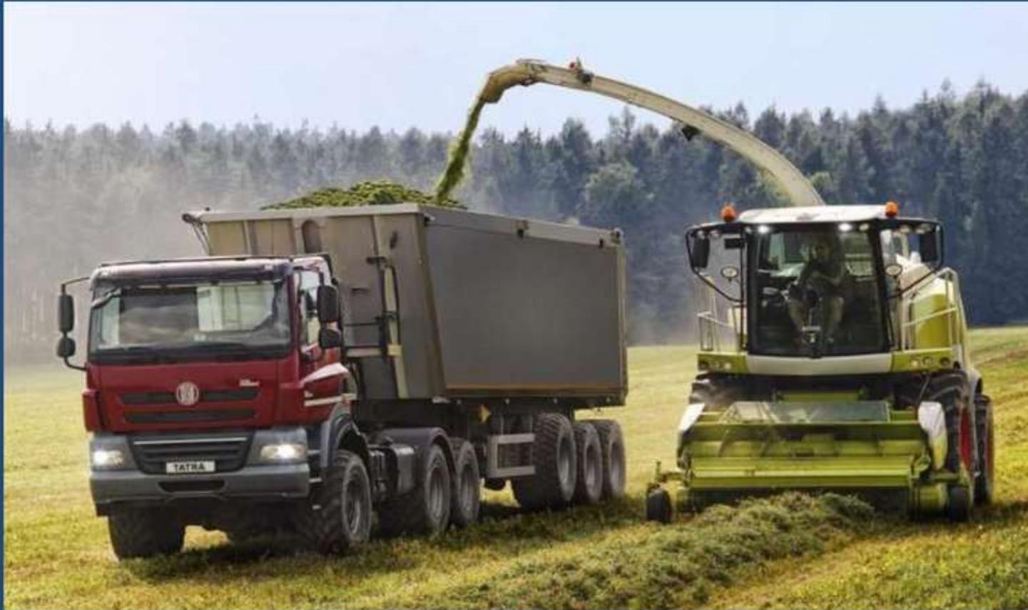
TATRA Agrotrak – трехосный полноприводный седельный тягач семейства T158 Thoenix с односкатными колесами. Для улучшения маневренности управляемыми сделаны колеса не только первой но и третьей оси ( на скорости до 40 км/ч).
