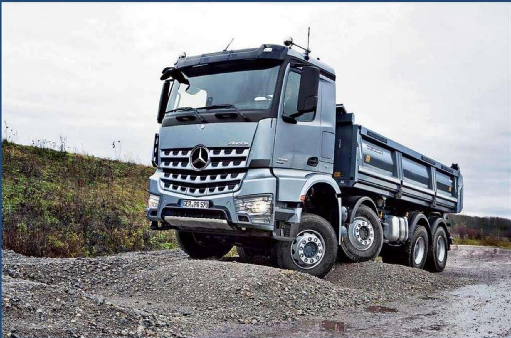
Mercedes-Benz нового семейства Arocs. Эти машины предназначены для работы в сложных условиях эксплуатации, прежде всего на стройках. Семейство включает широкий ряд моделей полной массой от 18 до 44 т с колесной формулой от 4x2 до 8x4.
