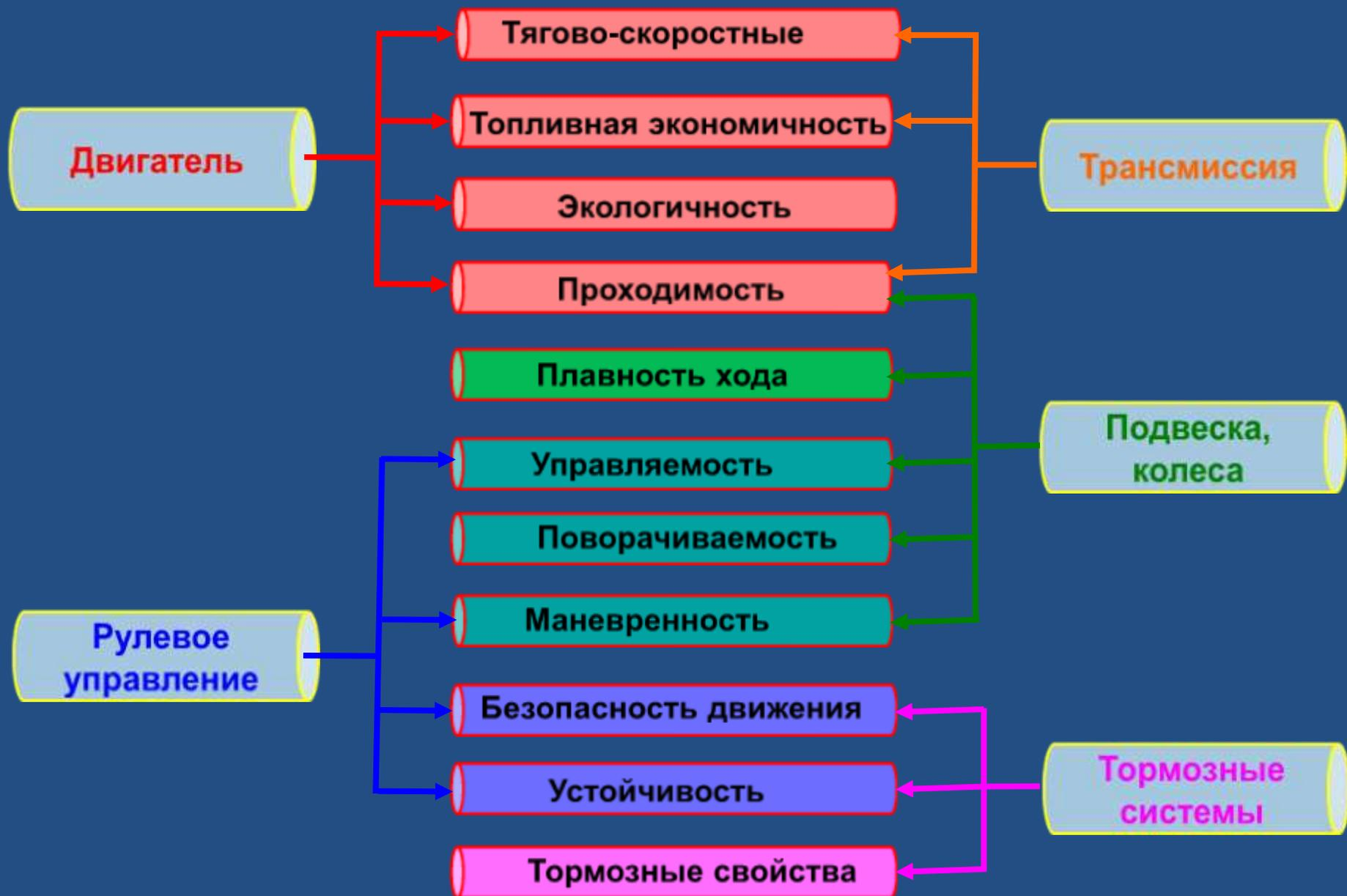
Автомобиль, его системы и механизмы конструируют таким образом, чтобы он имел определенные эксплуатационные свойства, требуемые для заданных условий эксплуатации и обеспечивающие его эффективное использование.
