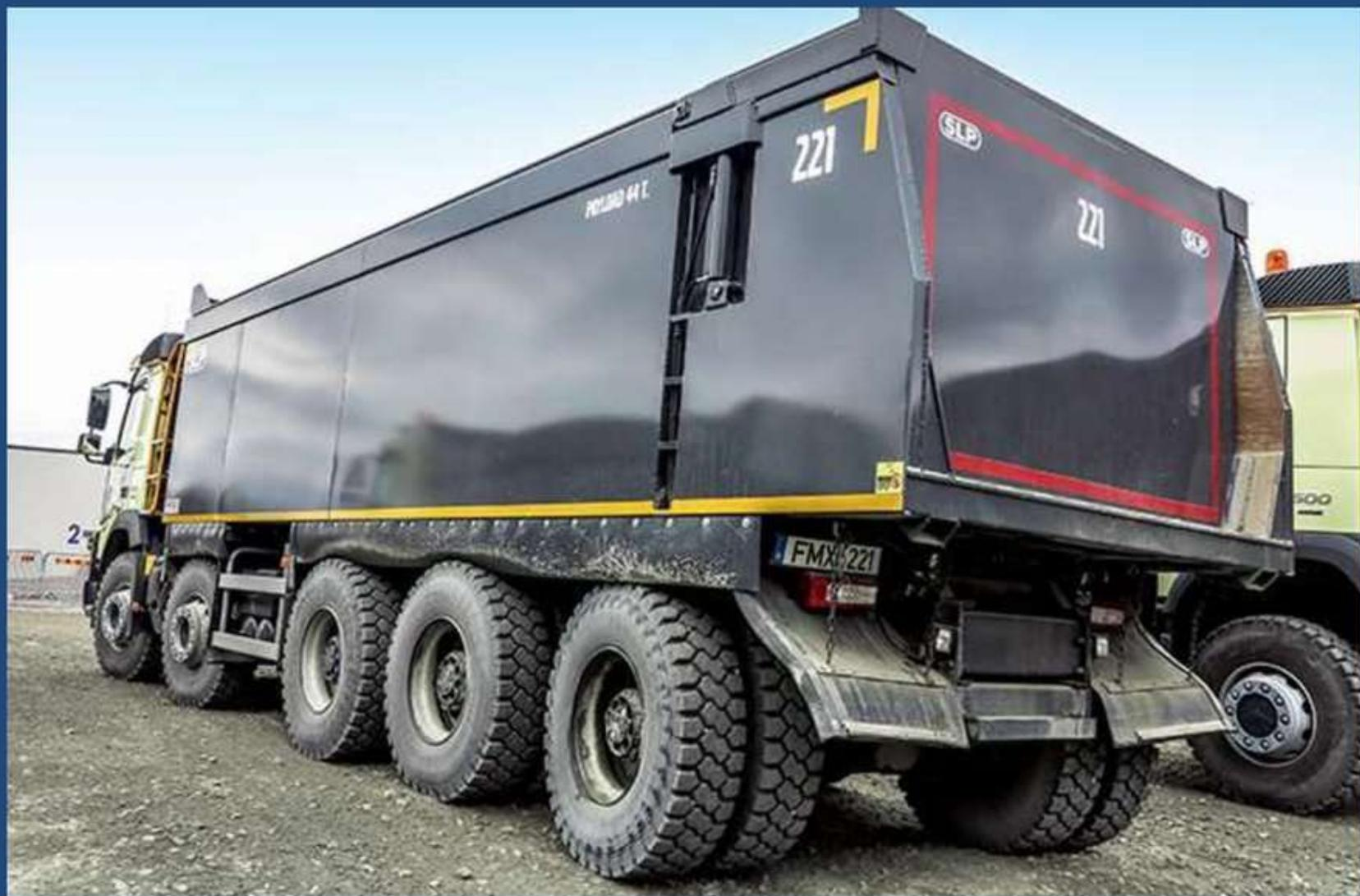
Пятиосный Volvo FMX с управляемой задней осью Terberg весит ни много ни мало – 66 тонн! Однако двигатель в 540 л. с. и «автомат» I-Shift резво разгоняет машину.
