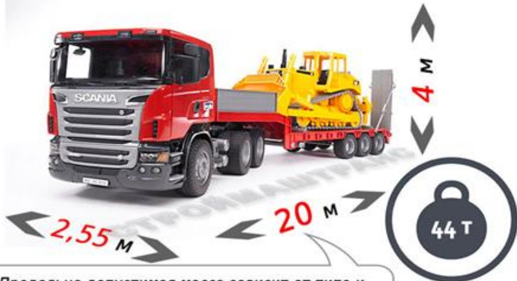
Предельно допустимая масса зависит от типа и количества осей транспортного средства. Приведенное значение действительно для автопоезда с шестью и более осями.
