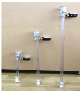
a) umumiy ko'rinish b) dalada o'rnatilishi d) manometr ko'rinishi 1.23-rasm. Tuproq namligini nazorat qiluvchi tenziometrlar.
