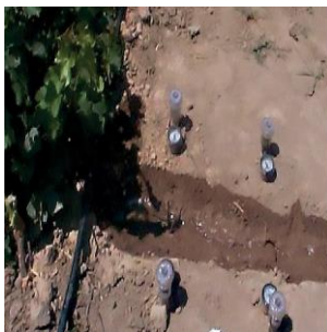
a) umumiy ko'rinish b) dalada o'rnatilishi d) manometr ko'rinishi 1.23-rasm. Tuproq namligini nazorat qiluvchi tenziometrlar.
