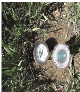
a) umumiy ko'rinish b) dalada o'rnatilishi d) manometr ko'rinishi 1.23-rasm. Tuproq namligini nazorat qiluvchi tenziometrlar.
