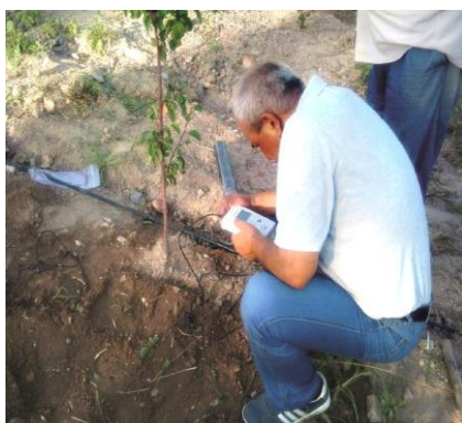
1.26-rasm. Ekin dalasiga o'rnatilgan tuproq namligi datchiklaridan ma'lumotlar olish
