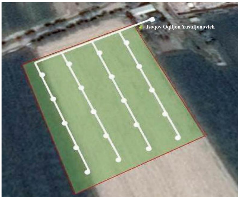
12.14-rasm. Quriladigan statsionar yomg'ir latib sug'orish tizimi sxemasining ekin maydoni xaritasida aks etishi (Namangan viloyati Yangiqo'rg'on tumanidagi "Isoqov Oqiljon" fermer xo'jaligi dalasi misolida).
