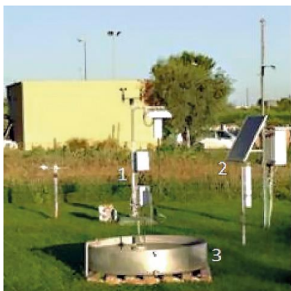
1 – agrometeostansiya, 2 – quyosh batareyasi, 3 – “A” tipidagi bug‘lantirgich
