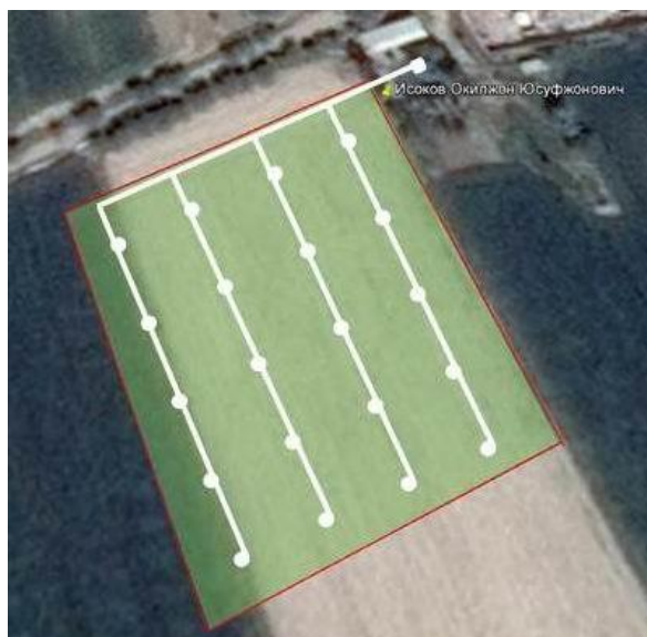
8-расм – Қуриладиган ёмғирлатиб суғориш тизими схемасини экин майдони харитасида акс этиши
