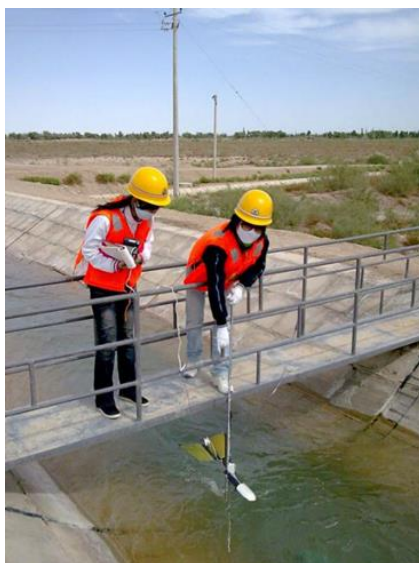
12-rasm. Suv yetkazib beruvchi kanalda suv oqimi tezligini o'lchash
