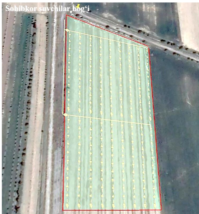
9.1-rasm. Namangan viloyati Yangiqoʻrgʻon tumanidagi “Sohibkor suvchilar” fermer xoʻjaligi bogʻida qurilgan tomchilatib sugʻorish tizimini ekin dalasi xaritasida aks ettirilishi misoli (Mamatov S., 2015 yil).
