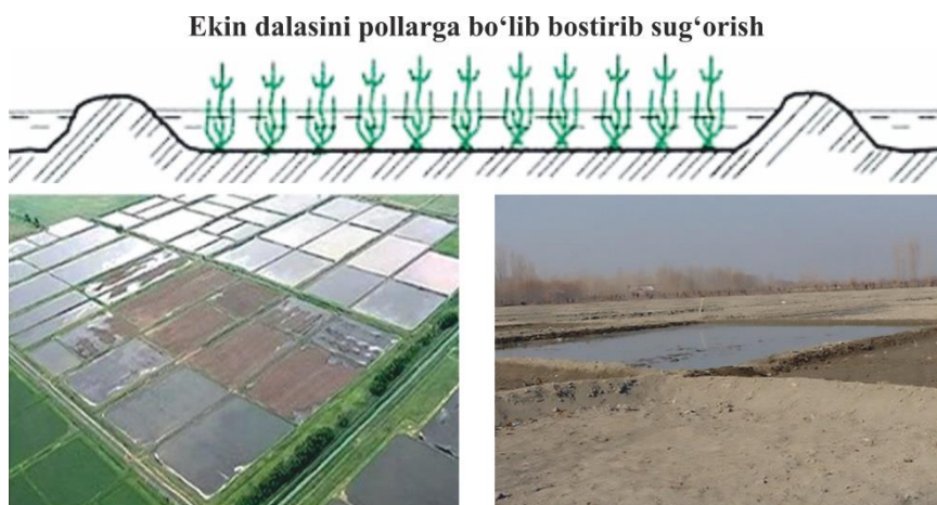
2.3-rasm. Ekin dalasini pollarga bo‘lib bostirib sug‘orishning sxematik va umumiy ko‘rinishlari
