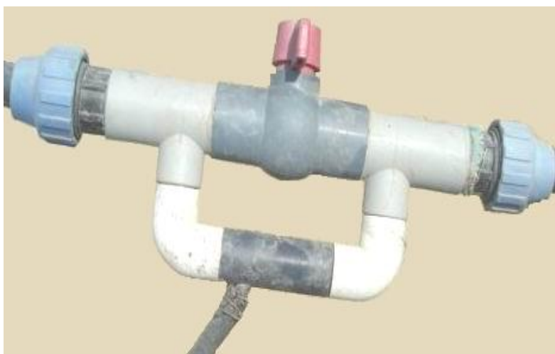
3.12-расм – Томчилатиб суғориш тизими таркибидаги ўғит етказиб берувчи Вентури инжектори
