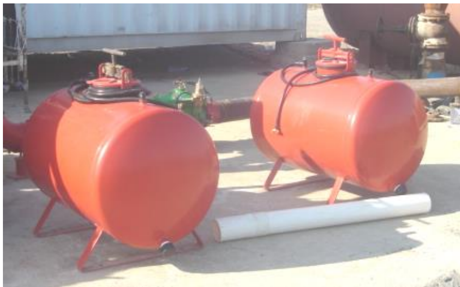
3.13-расм – Томчилатиб суғориш тизими таркибидаги ўғит тайёорловчи ва етказиб берувчи идиш
