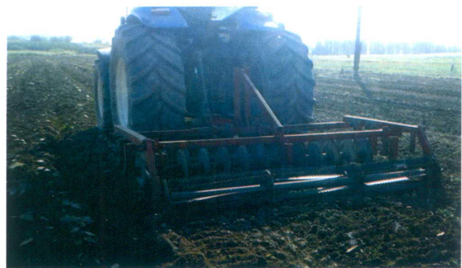
1-расм. Янги шудгорланган ерларни экишга тайёрловчи комбинациялашган машина
