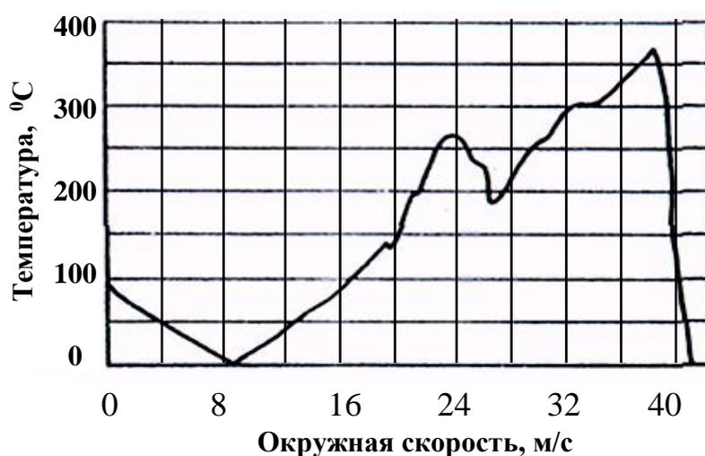
**Рис.1.4. Зависимость температуры масляной пленки на поверхности зубьев колес от окружной скорости [18]**
