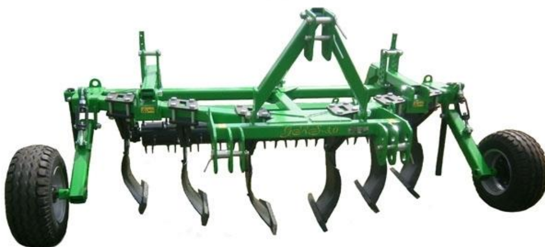
1.3-расм. Ёйсимон GRS 3 русумли чуқур юмшаткич
