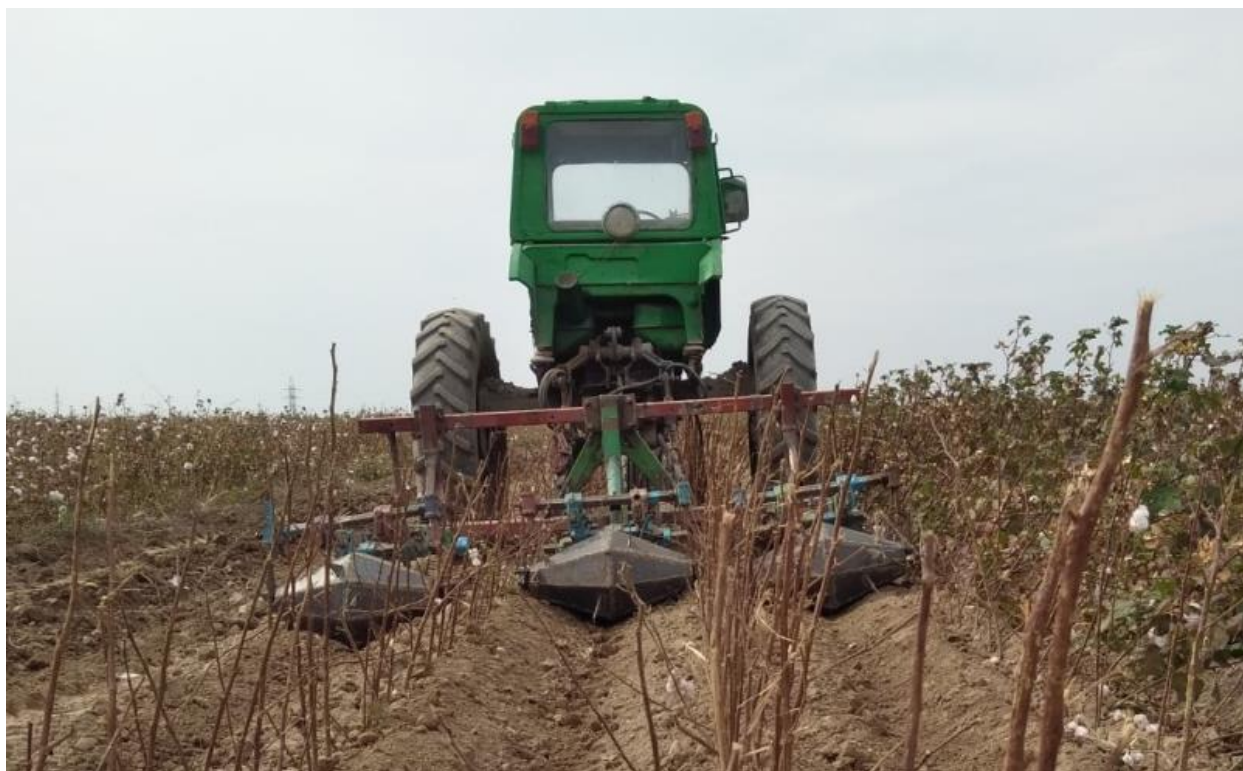
5.20-расм. Экспериментал машина ишчи органларининг юмшатишган эгат шаклини ҳосил қилиш иш жараёни
