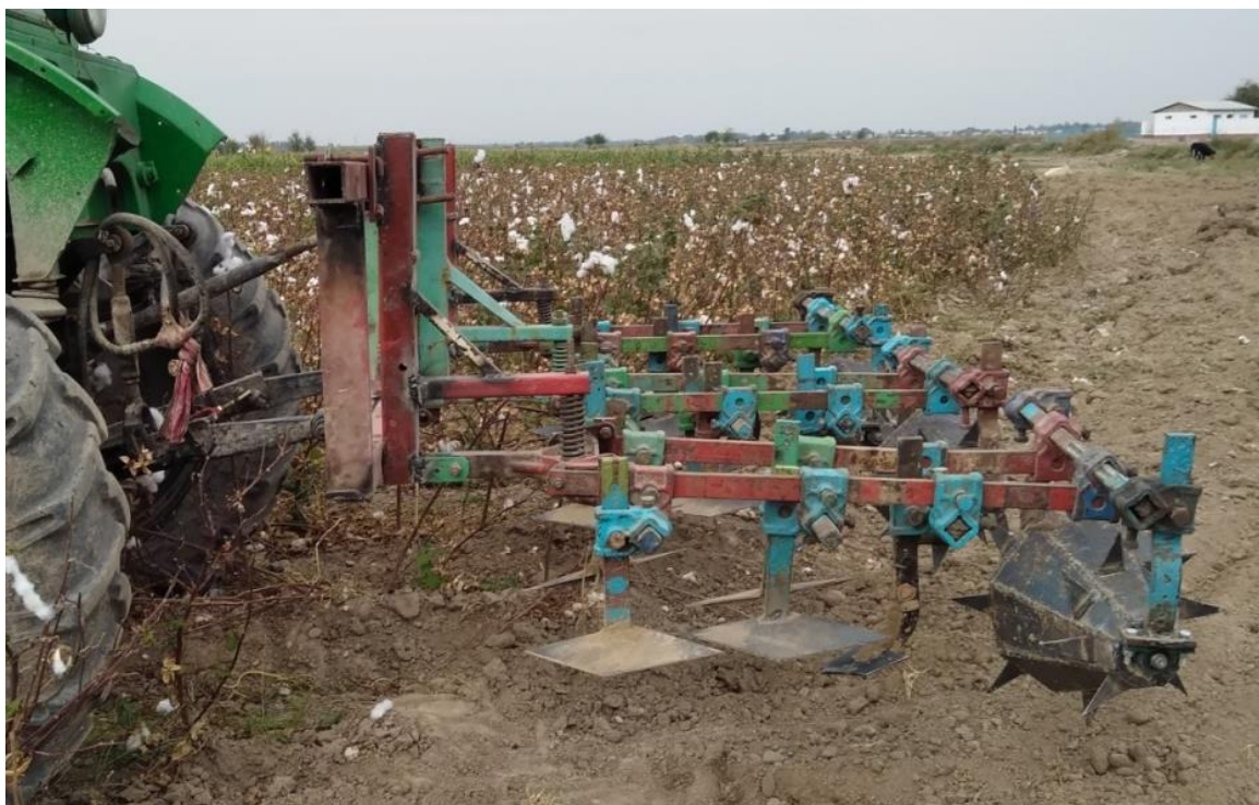
5.19-расм. Экспериментал машина ишчи органларининг ўрнатилиши
