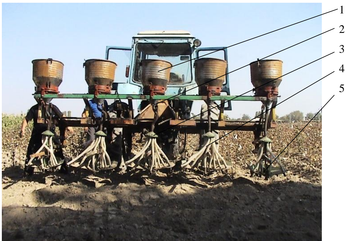
1-бункер, 2-марказий уруғ ўтказгич, 3-уруғ тақсимлагич, 4-уруғ ўтказгичлар, 5-пичоқли сирпанма эккич
