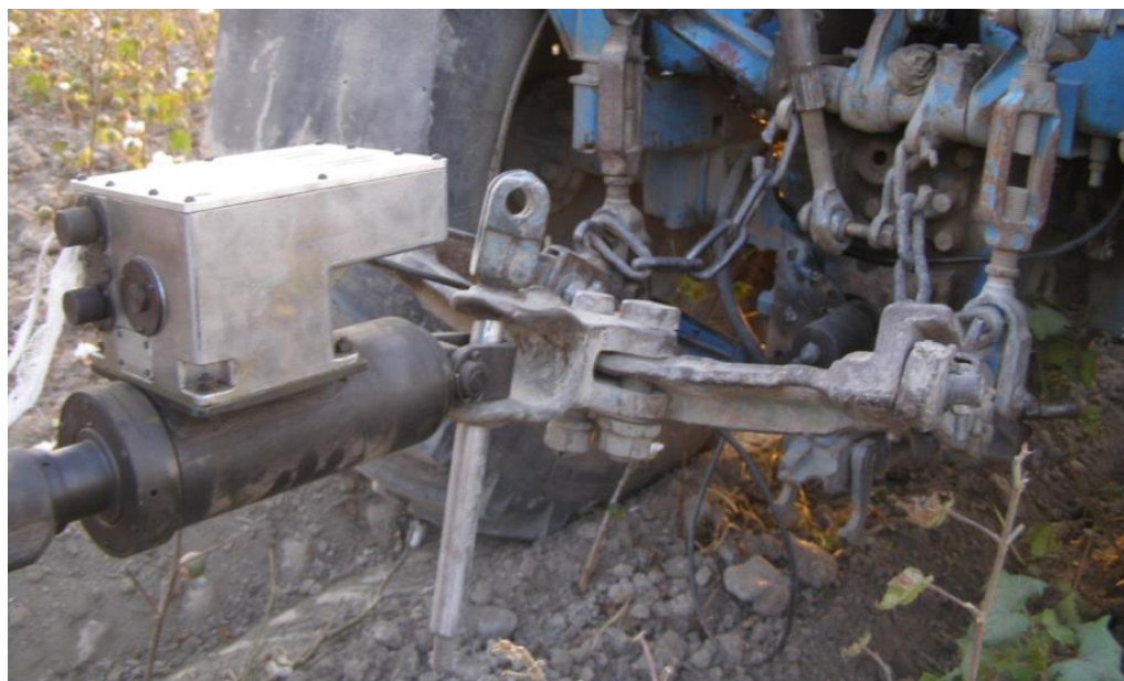
6.14-расм. Агрегат қаршилигини аниқлашда қўлланилган работамер
