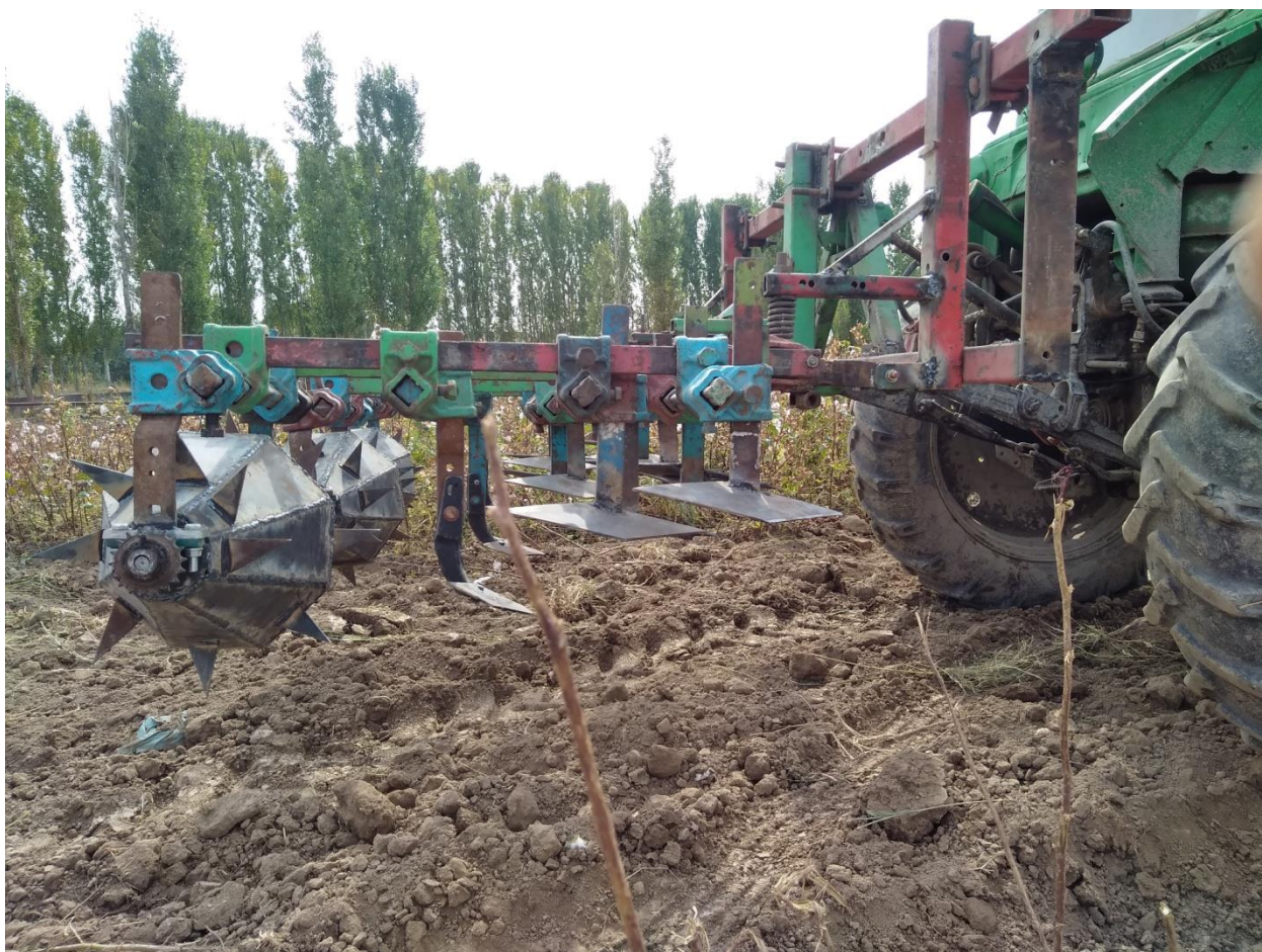
6.5-расм. Ғўза қатор ораси тупроғига кузги буғдой экиш олдида ишлов берадиган техник восита
