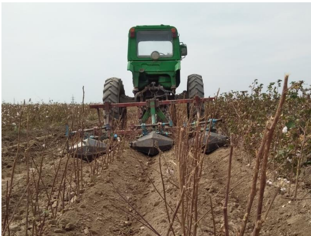
4.23-расм. Экспериментал машина ишчи органларининг юмшатишган эгат шаклини ҳосил қилиш иш жараёни
