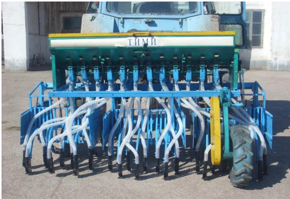
6.7-расм. Ғўза қатор орасига кузги буғдой экадиган анкерли экичлар билан жихозланган сеялка
