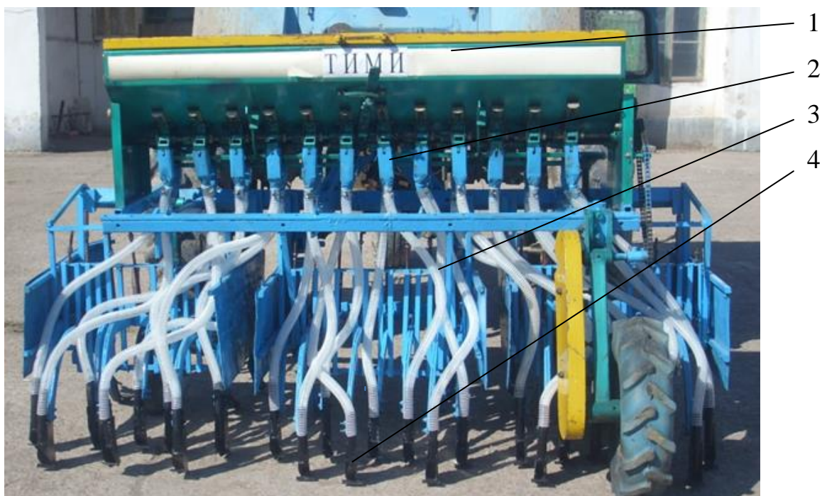
1-бункер, 2-галтакли уруғ тақсимлагич, 3-уруғ ўтказгичлар, 5-анкерли эккич
