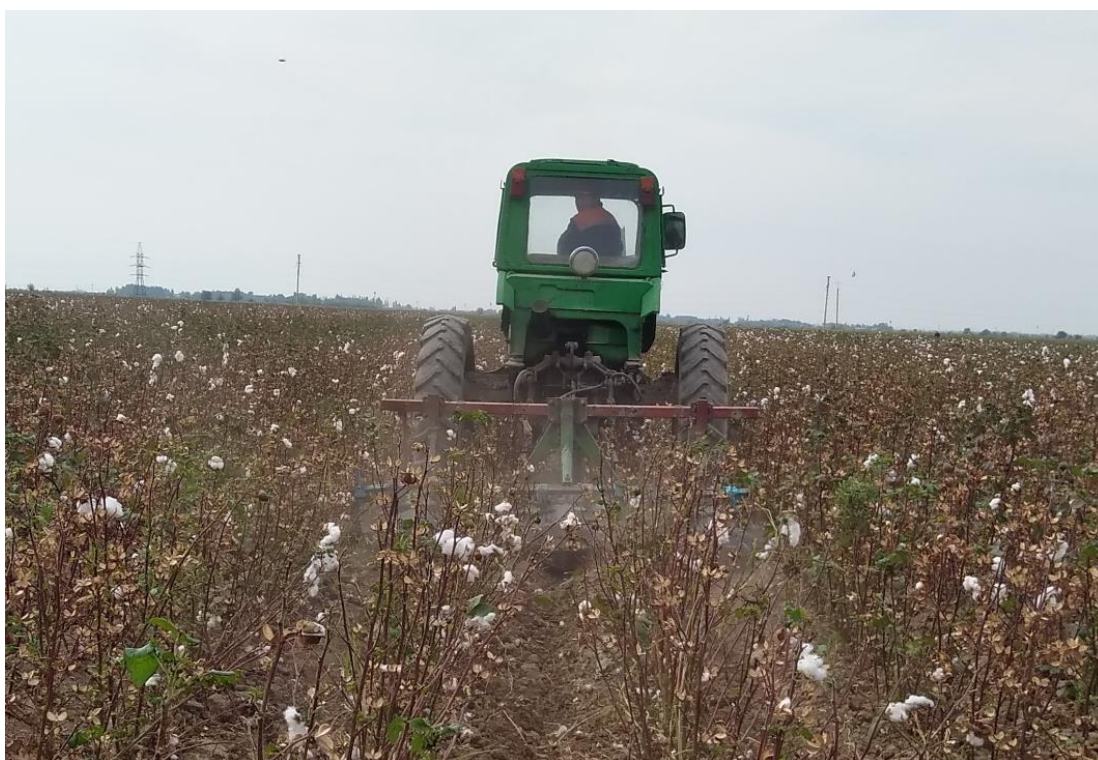
4.24-расм. Экспериментал машинанинг ғўза қатор орасига ишлов бериш жараёни
