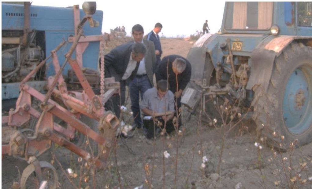
6.15 - расм. Агрегатнинг тортишга қаршилигини тадқиқ этиш жараёни
