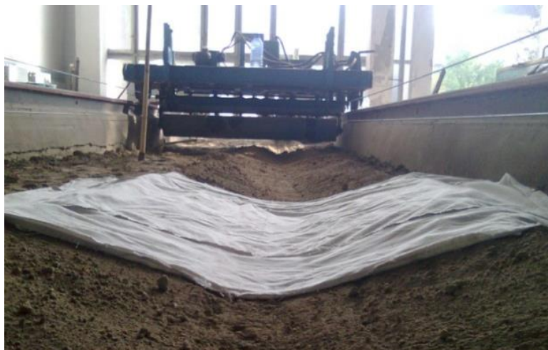
3.6-расм. Тупроқ каналида ғуза қатор орасига мослаштирилган пушта тайёрлаш жараёни
