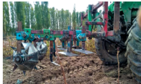
4-расм. Гўза қатор ораси тулроққа кўза бурғой экин олдидан қатламни ва сифатли ишлов берадиган техник восита
