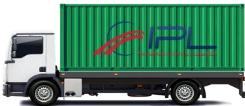
27 - rasm. 20 futli konteynerga ega boʻlgan 10 tonnalik fura
