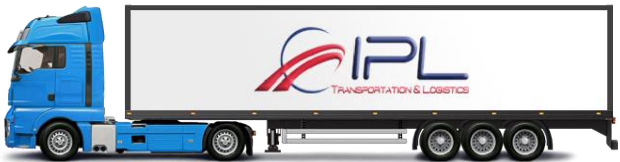
23 - rasm. Izotermik va refrijeratorli yarim pritsep
