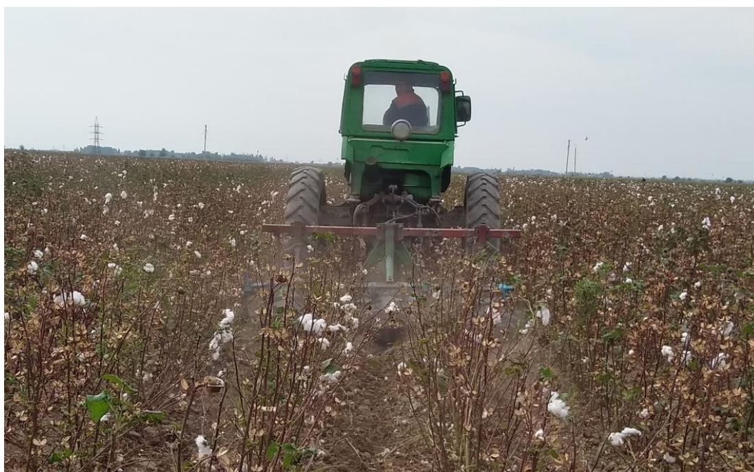
5.21-расм. Экспериментал машинанинг ғўза қатор орасига ишлов бериш жараёни
