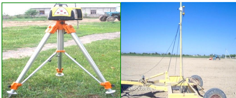
30-rasm. Lazer boshqaruvli (a) er tekislagichning (b) ko‘rinishi
