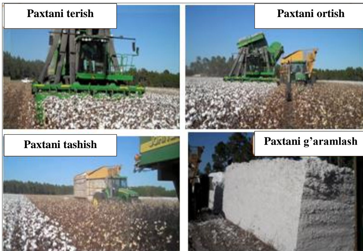
55-rasm. Paxtani g'aram holatda tayyorlash texnologiyalari
