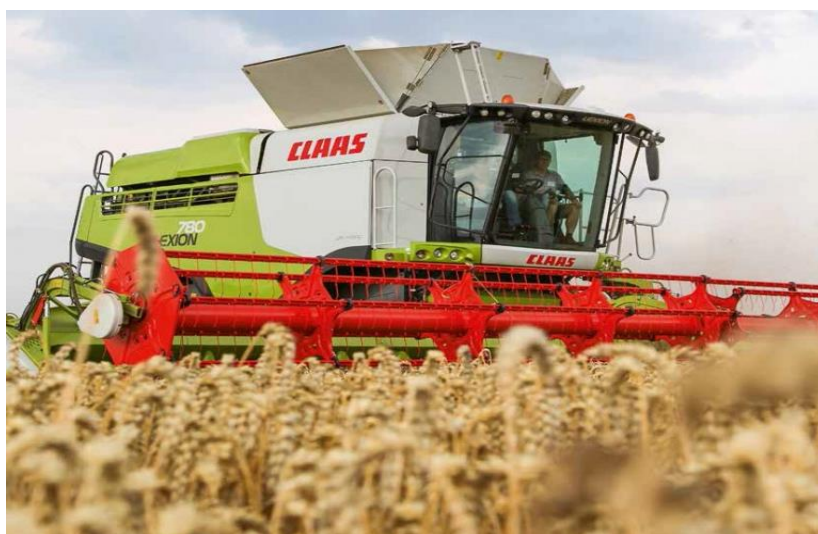
56-rasm. G‘allani bir fazali usulda yig‘ishtirib olish jarayoni
