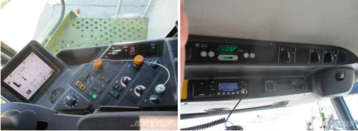
94-rasm. Klaas kompaniyasi “Lexion” kombaynini bort kopyuteri
