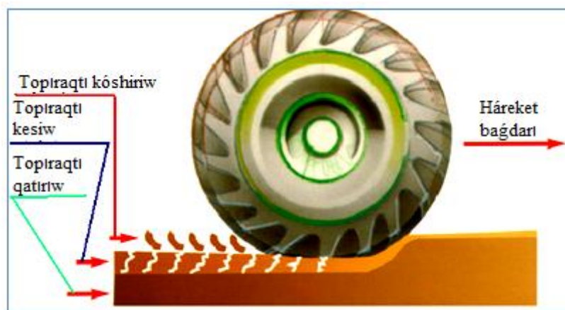
3.1-súwret. Traktor dóńgeleklerin tayǵanaqlaw processsi
