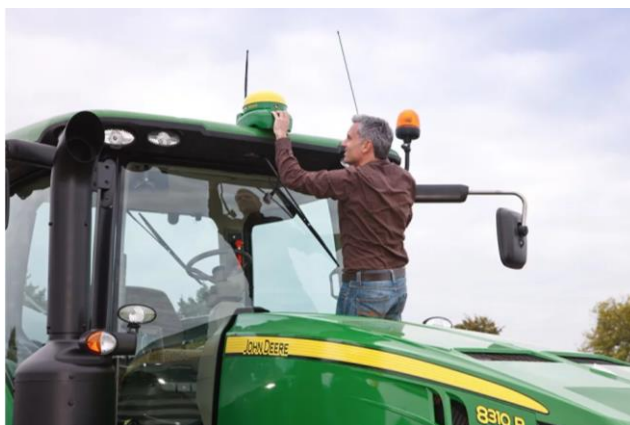
9.10-súwret. Traktorlardı GPS qurilmaları menen úskenelew
