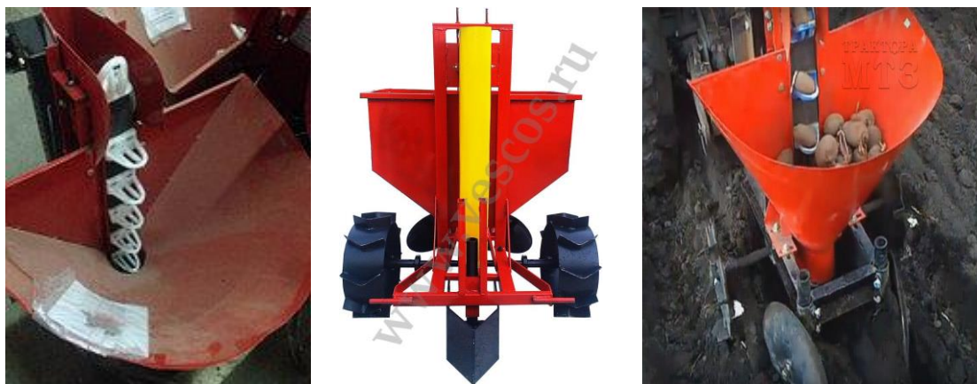
99-rasm. Kartoshka ekish seyalkasining umumiy ko'rinishi va ish jarayoni
